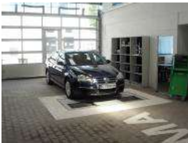
Fig.2. Linia de testare a sistemului de frânare.
