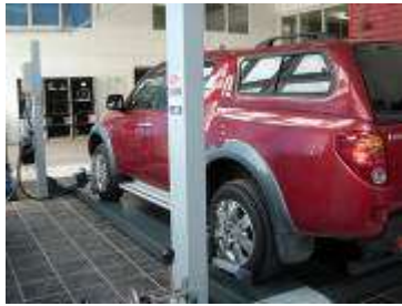
Fig.1. Linia de testare și reglaj direcție.
