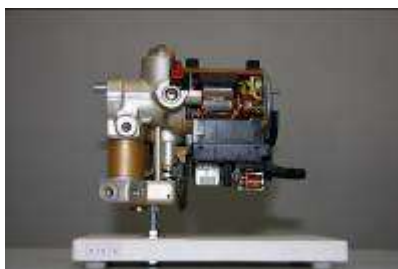
Fig. 8. Sectiune prin modulul ABS.
