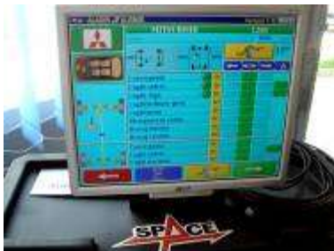
Fig.4. Măsurarea parametrilor direcției.
