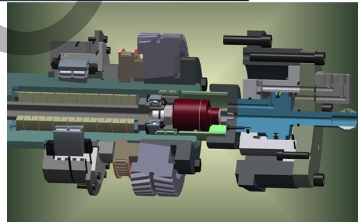
Lagăr "spate", secțiune prin roată de curea și prin cilindru hidraulic de eliberare a sculei la mașină CPH 1-5, (STIMIN, ORADEA).
