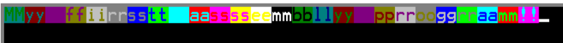
Figura 14.9. Posibilitatea afișării multiple a fiecărui caracter prin utilizarea întreruperii int 10h cu serviciul 09h
