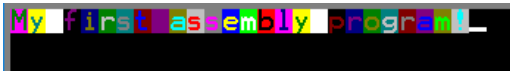
Figura 14.8. Posibilitatea afișării colorate a fiecărui caracter prin utilizarea întreruperii int 10h cu serviciul 09h
