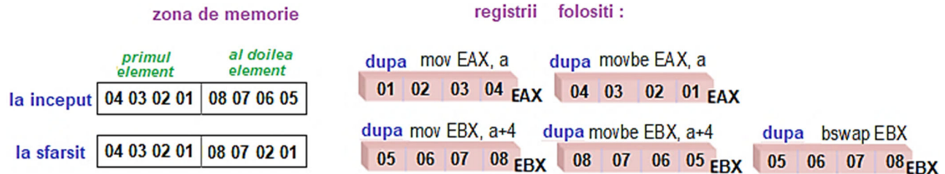
Figura 2-3.3. Ilustrarea modului de aranjare a datelor în memorie pentru exemplul 2-3.5, ca dublucuvinte în format Little Endian (înainte și după execuția secvenței de instrucțiuni) (valorile octeților au fost exprimate în hexazecimal)
