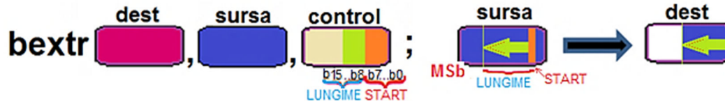
Figura 4-5.8. Ilustrarea modului de operare al instrucțiunii BEXTR
