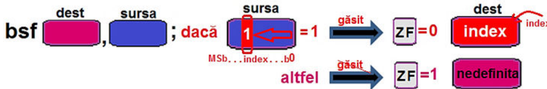
Figura 4-2.6. Ilustrarea modului de operare al instrucțiunii BSF
