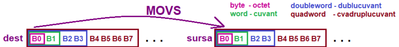
Figura 5-1.1. Ilustrarea modului de operare al instrucțiunii MOVȘ[-B/W/D/Q]
