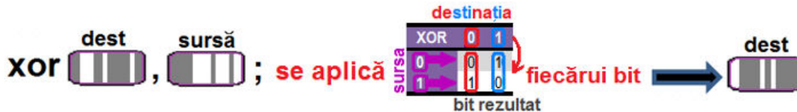
Figura 4-1.4. Ilustrarea modului de operare al instrucțiunii XOR
