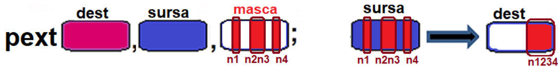
Figura 4-5.15. Ilustrarea modului de operare al instrucțiunii PEXT
