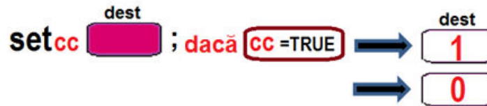
Figura 4-2.8. Ilustrarea modului de operare al instrucțiunii SETcc
