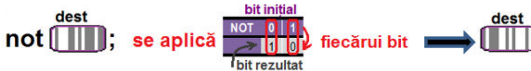
Figura 5-1.1. Ilustrarea modului de operare al instrucțiunii NOT
