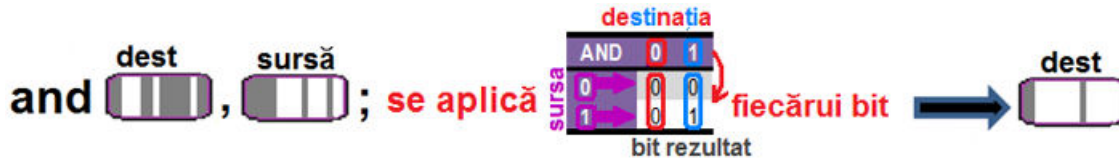
Figura 4-1.2. Ilustrarea modului de operare al instrucțiunii AND
