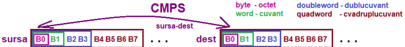
Figura 5-1.4. Ilustrarea modului de operare al instrucțiunii CMPS[-B/W/D/Q]
