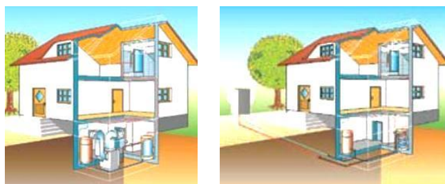
Fig. 9.2 Pompă de căldură de tip aer – apă montată în interiorul, respectiv în exteriorul locuinței [57]
