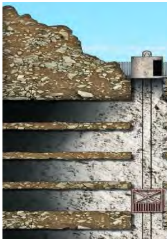
Figura 1.12. Puț de mină, legătura dintre suprafață și diferitele orizonturi ale minei, prin intermediul galeriilor
