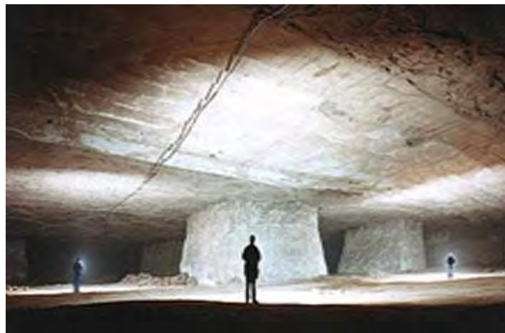
Figura 1.19. Cameră subterană și pilier de siguranță
