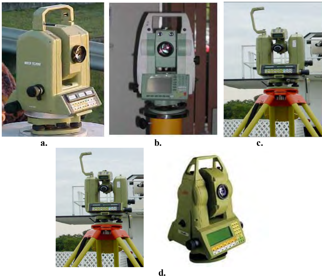
Figura 12. a. Leica (Wild) TC2002 , b. TCRA 1325, c. Leica (Wild) DI2002, d. De la teodolit electronic+EDM la stație totală Leica TC2003 Total Station (197)
