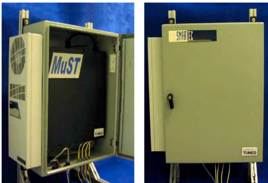
Figura 67. Sistemul de Măsurare MuST pentru instalare permanentă pe teren (199, 211)
