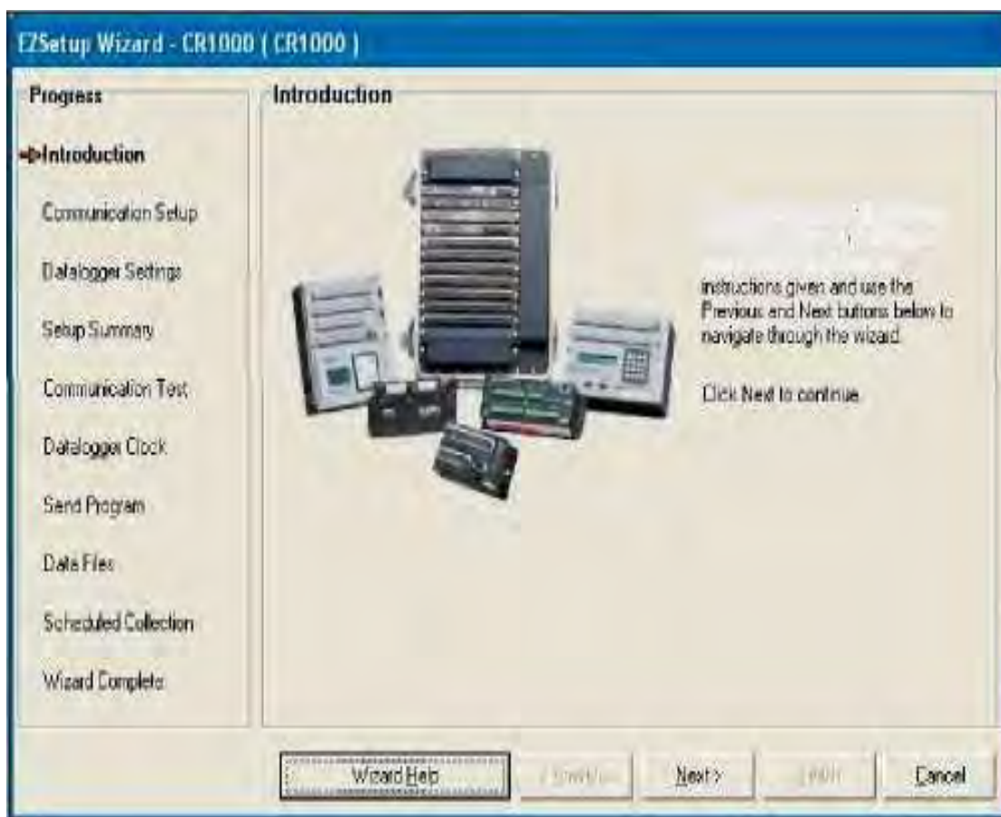
Figura 48. Dispozitivul pentru setarea EZ oferă ajutor pas cu pas în stabilirea și configurarea acumulatorului de informații pentru comunicarea și colectarea datelor Campbell Scientific (197, 217)
