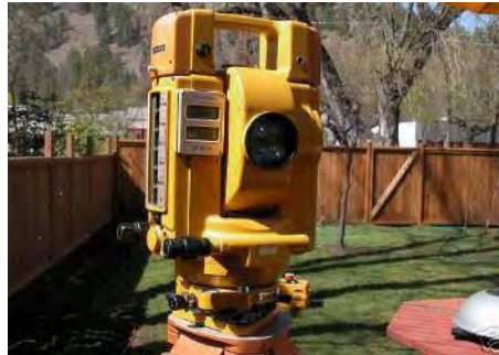
Figura 9. Prima Stație Topografică totală produsă în serie de Topcon SUA+Japonia, Topcon ET-1, în anii 1980+(197)
