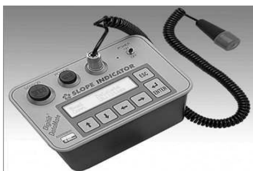
Figura 26. Unitatea de prelucrare a datelor Digitilt Data Mate compact funcționează 16 ore cu o singură încărcare, înmagazinează până la 320 de evaluări și transferă datele într-un computer pentru procesare (172)
