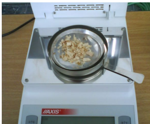
Figura 1-2.9. Cântărirea probelor de material suspuse determinărilor experimentale
