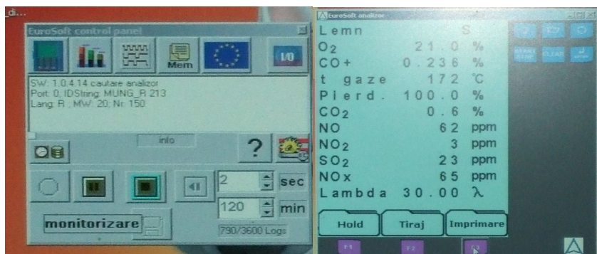
Figura 7.2.: Programul de calculator EUROSOFT - Interfața de comandă și colectare a datelor de pe analizorul de gaze prin intermediul unei unități PC
