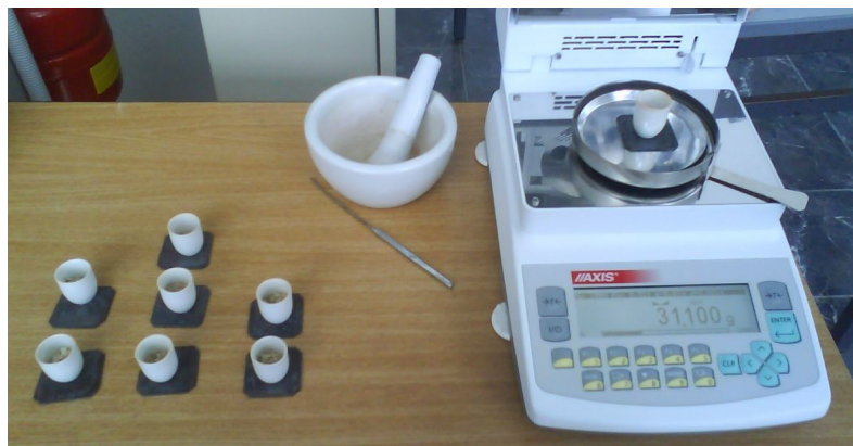
Figura 1-2.15. Eșantionarea și cântărirea creuzetelor cu probele de analiză
