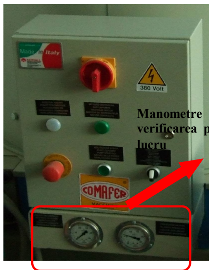
Figura 5.2. Manometre pentru verificarea presiunii de lucru a mașinii de brichetat
