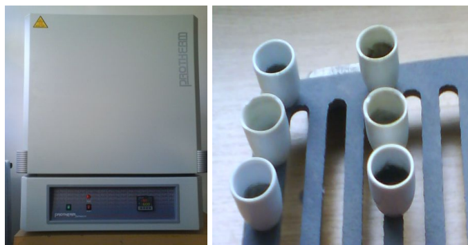
Figura 1-2.15. Eșantionarea și cântărirea creuzetelor cu probele de analiză
