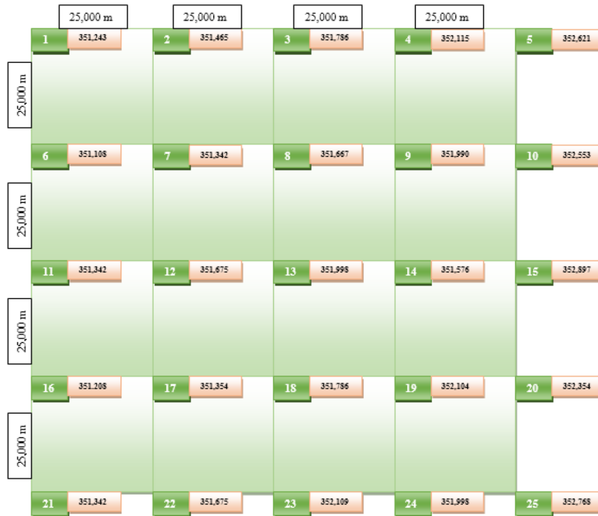
Figura 1.59. Platforma care se va amenaja cu o declivitate impusă de i=1,2\% , caroierea 25,000 \times 25,000 m, numerotarea colțurilor de caroiaj și cotele terenului natural determinate prin nivelment geometric de mijloc
