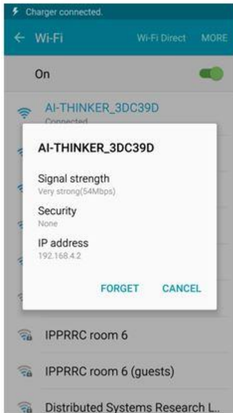
Fig.VIII.3. Numele modulului ca access point wifi
