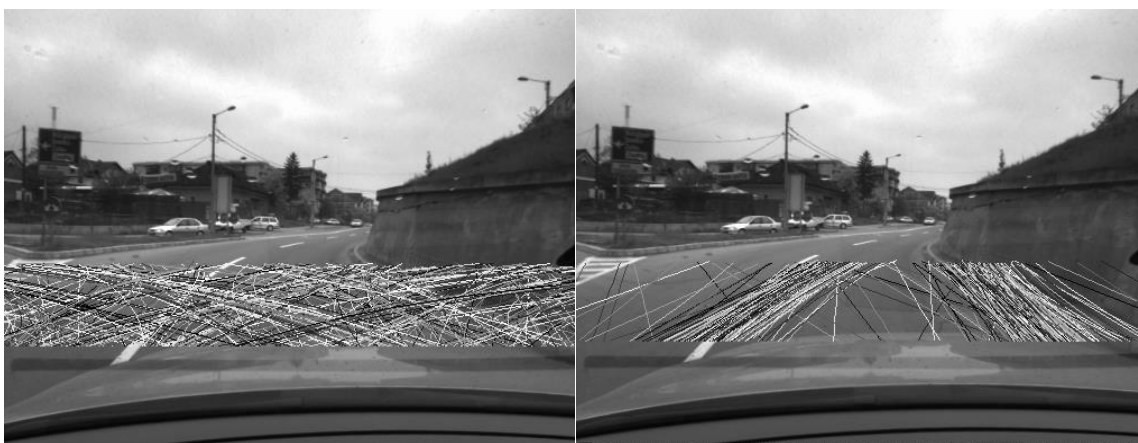
Fig. 6. Particulele în spațiul imagine [13]. Stânga – particule complet aleatoare, la pornirea sistemului; dreapta – particule precise în modul de urmărire normal, unele fiind complet aleatoare, dar cele mai multe fiind apropiate de banda reală.
