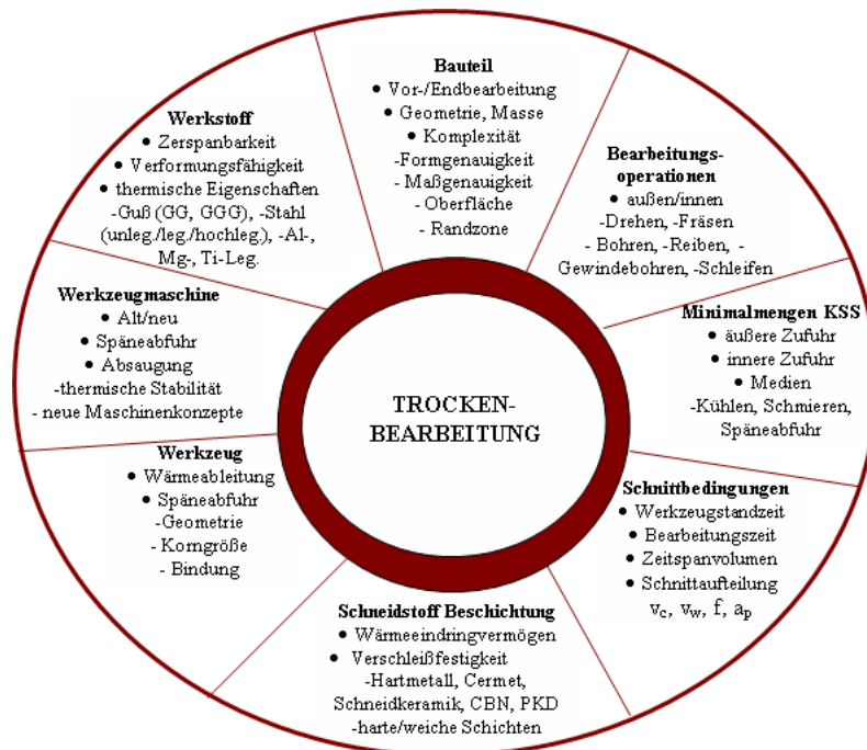
Abb.5.6 Technologische Voraussetzungen für Trockenbearbeitung / Premize tehnologice la aşchierea uscată [FRA 08]
