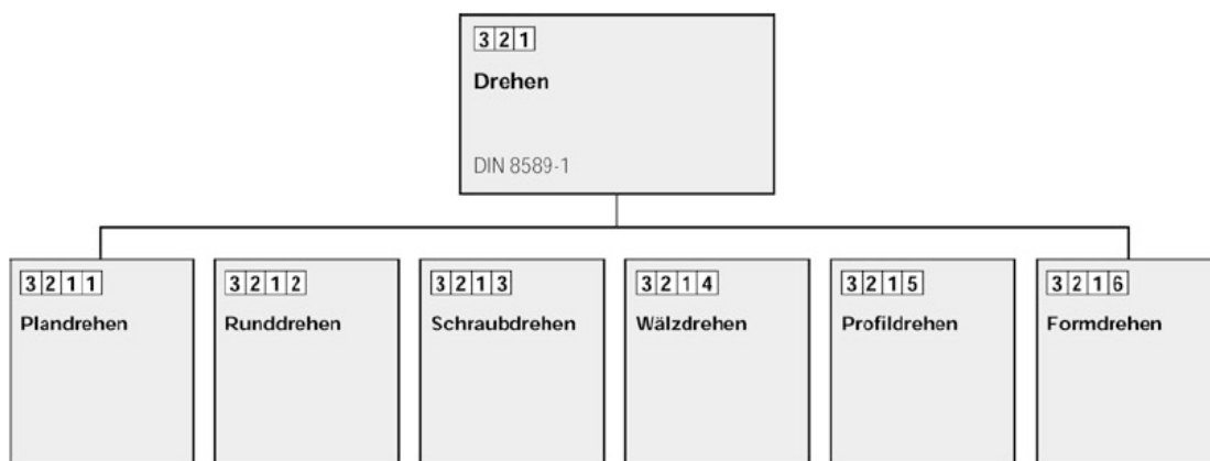
Abb. 3.2. Einteilung der Drehverfahren nach DIN 8589, Teil 1 / Clasificarea proceselor de strunjire
