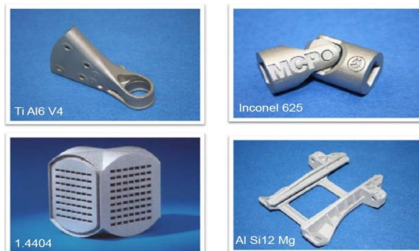
Fig. 10.11. Piese realizate prin topire selectivă cu laser (SLM) din diferite material [BAL 01]
