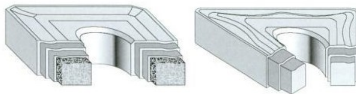
Fig. 4.24. Plăcuțe cu acoperiri metalice multistrat
