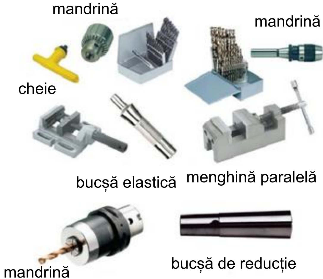
Fig. 50. Dispozitive folosite la burghiere
