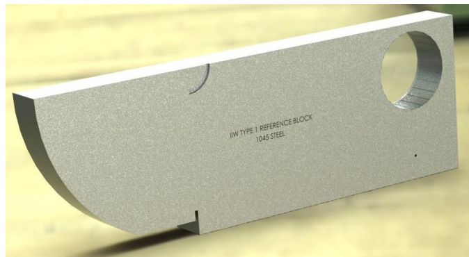
Figura 30. Dimensiunile nominale (a) și imaginea (b) blocului de referință A 1 [1, 4].
