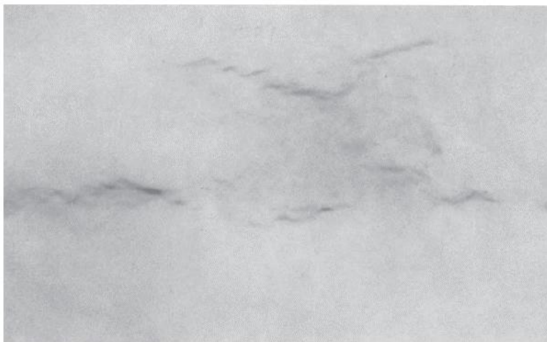
Fisuri rezultate în urma contracției la solidificare a unei piese turnate din aliaj de aluminiu
