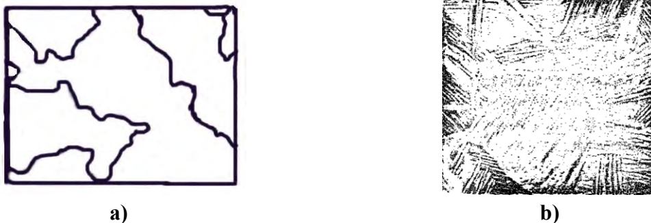
Figura 6.4. Reprezentarea schematică a microstructurii fierului alfa obținută prin transformare: a) masivă și b) mecanism martensitic [12].
