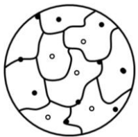
Aliaj format din cristale primare de soluție solidă și cristale secundare globulare de compus.
