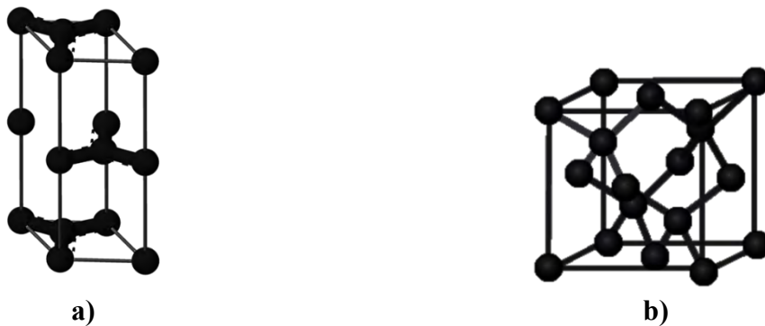
Figura 2.2. Exemplificarea aranjamentului metastabil și stabil al atomilor în cazul atomilor de carbon: a) grafitul – forma stabilă cu structură hexagonală și b) diamantul - forma metastabilă cu structură cubică cu fețe centrate de tip diamant.
