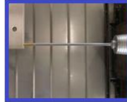
Figura 3 Burghie pentru găuri adânci (www.lti-motion.com, 2019)
