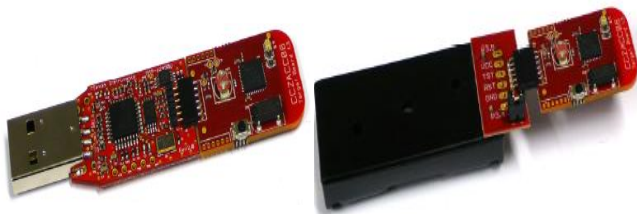
Figura 2 Sistemul de dezvoltare eZ430-RF2480
