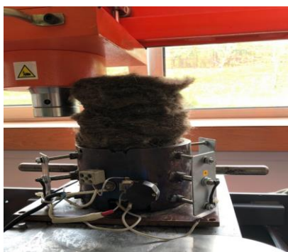
Fig. 1. Pregătirea materiei prime de a fi presată în matriță.
