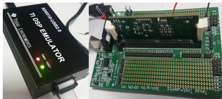
Fig. 5.16. Interfața – emulator jTAG – USB (stânga) și procesor digital de semnal DSP (dreapta)
