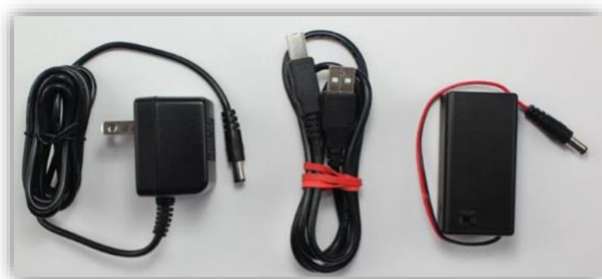
Fig. 2. Tipuri de alimentare pentru plăcuțele Arduino
