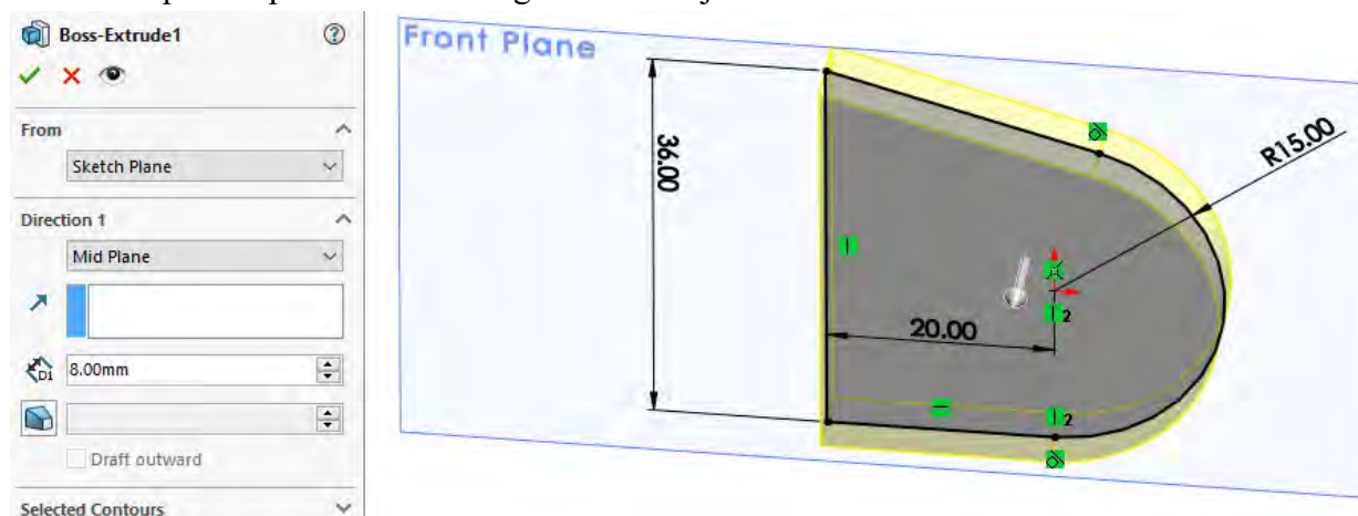
Figura 146. Extrudarea profilului pe distanța de 8 mm
