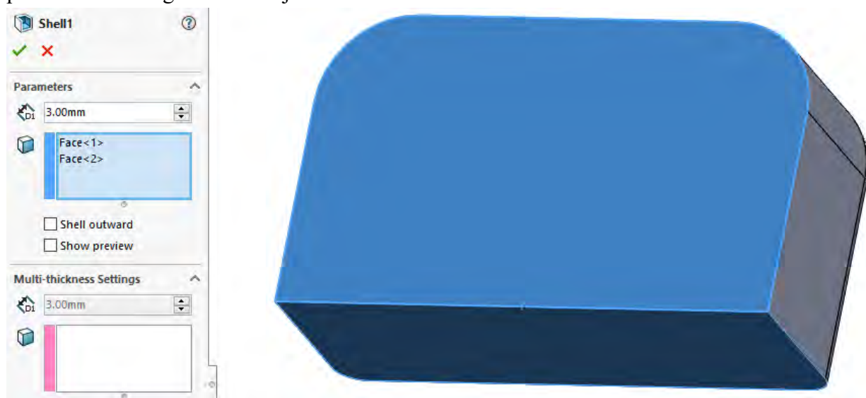
Figura 168. Înlăturarea materialului din interiorul carcasei
