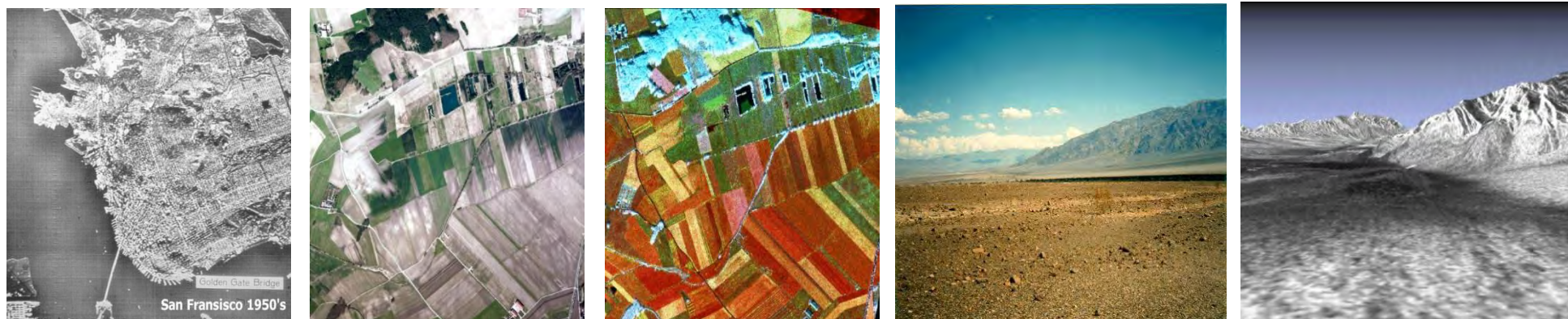
Figura 4.8. Radar de tip SLAR și SAR, a. San Francisco în anii 1950, imagine achiziționată de un sistem SLAR timpuriu[125], b. Deosebirea dintre o fotografie color(stânga) și o imagine procesată pe baza datelor obținute prin sistemul Radar(dreapta)[126, 127], c. Deosebirea dintre o fotografie color-Valea Morții, SUA(stânga) și Radar Derived DEM (Digital Elevation Model) elaborate pe baza datelor obținute cu un system Radar(dreapta)[128, 129]
