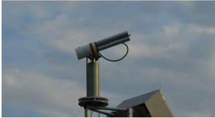
Figura 6.1. a. CE 318 automatic sun tracking photometer[1,8,9], b. Spectrometru utilizat pentru stabilirea gradului de reflectanță a solului[1]
