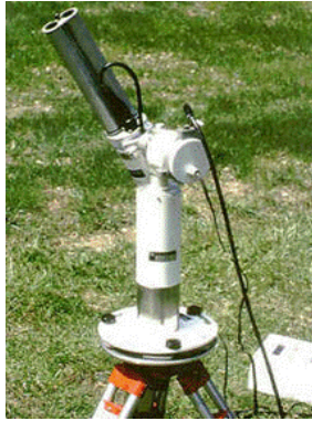
Figura 6.1. a. CE 318 automatic sun tracking photometer[1,8,9], b. Spectrometru utilizat pentru stabilirea gradului de reflectanță a solului[1]
