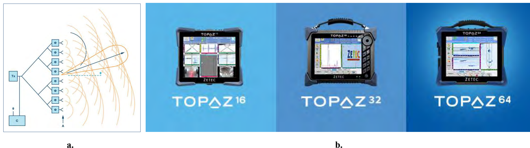
Figura 4.4. Exemple de utilizare a sistemelor senzoriale active Phased Array: a. Principiul de funcționare- Diagrama elementelor matrice în etape[40], b. Instrumente Topaz Phased Array produse de Zetec, Inc. [31]
