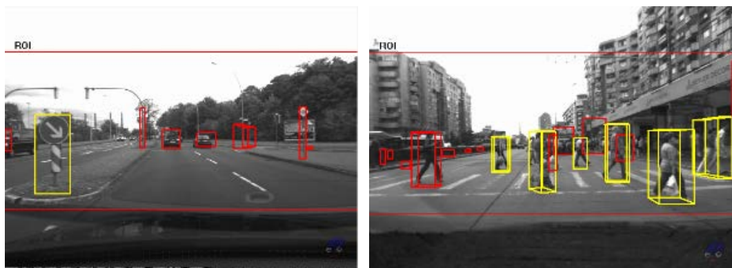
Figura 3.34. Clasificări eronate rezolvate prin utilizarea stereo-reconstrucției SORT-SGM (pietoni – cu culoare galbenă; celelalte obstacole – cu culoare roșie: un fals pozitiv de pieton (stânga); un fals negativ de pieton (dreapta))
