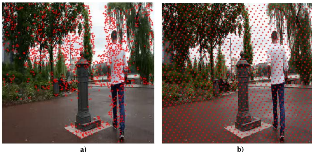
Figura 2.28. Selecția punctelor de interes (puncte de culoare roșie): a) pe baza trăsăturilor SIFT ; b) distribuite uniform pe o structura de tip raster
