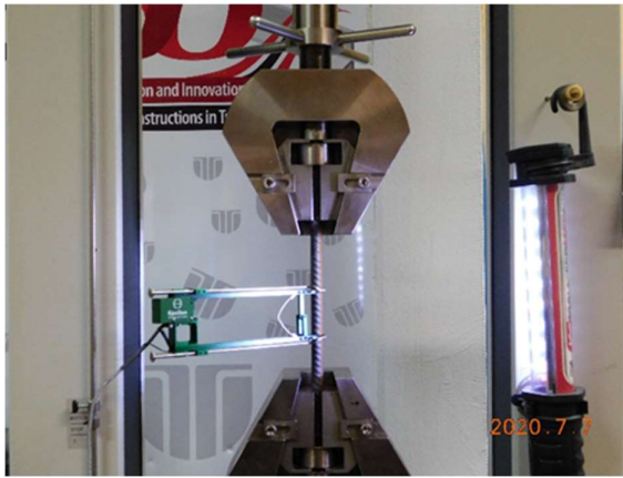
Fixarea epruvetei în presă
