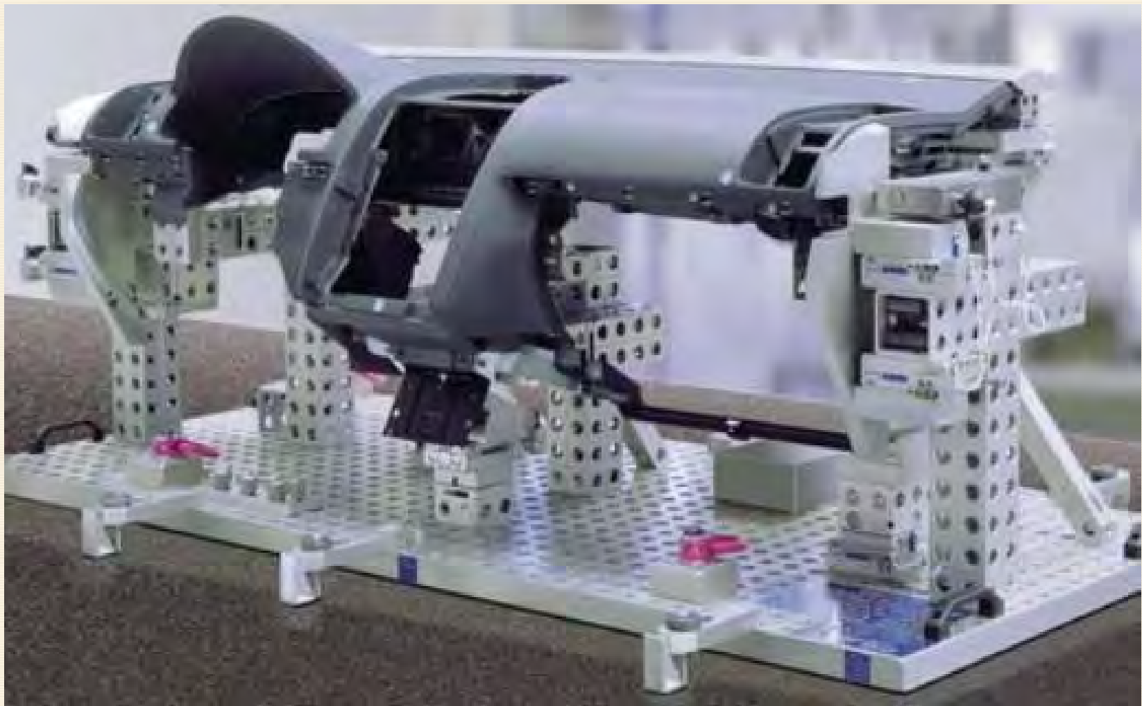
Fig.6.42. Fixare cu dispozitive modulare a unei piese pe o paletă [w.pre_20]
