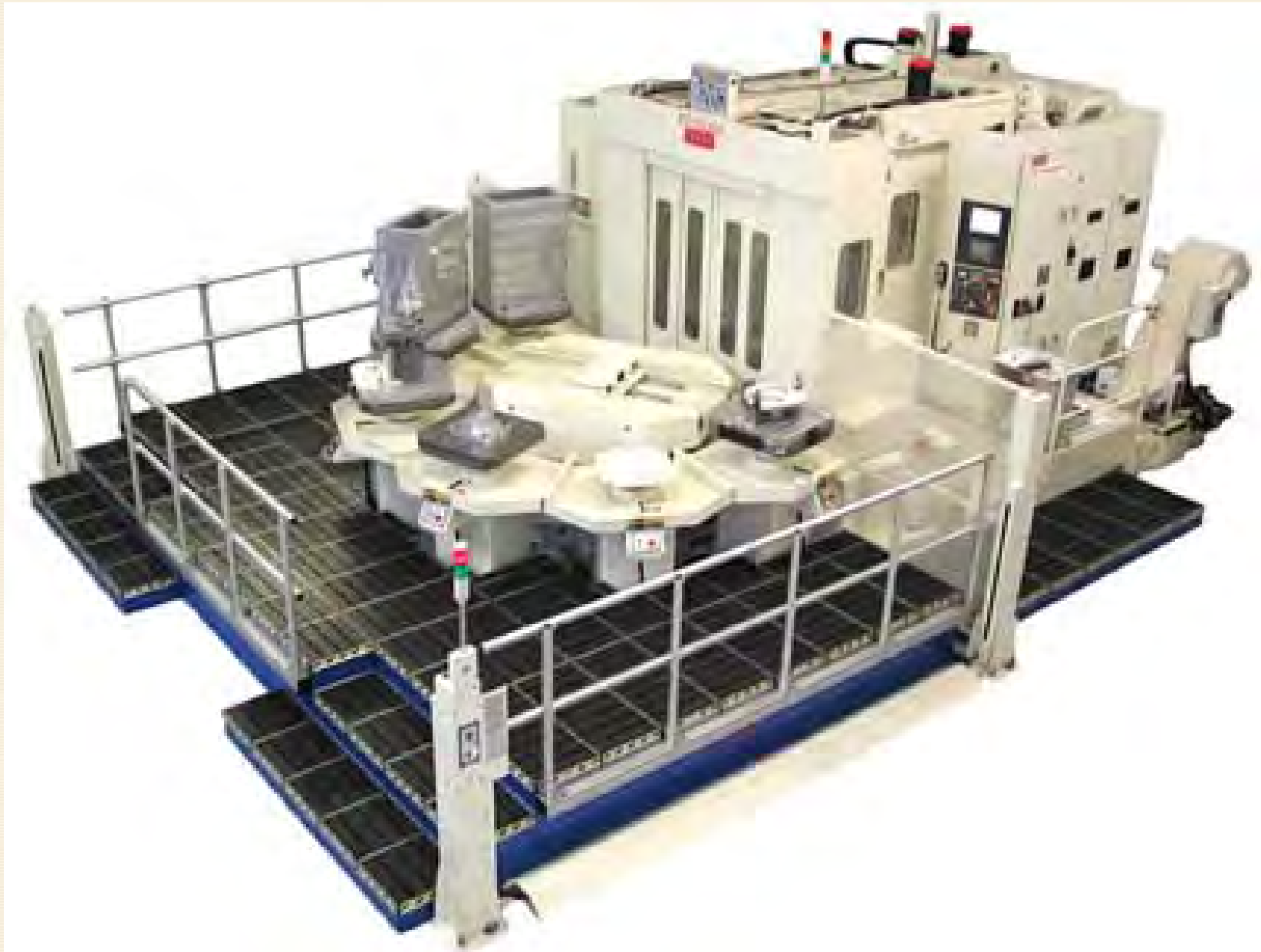
Fig.3.9. Centru CNC cu schimbător de palate integrat [w. cbm_17]
