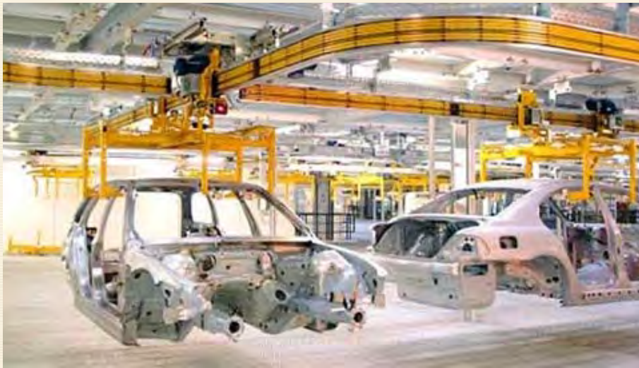
Fig.6.28. Conveiere suspendate a) [w.ove_17], b) [w.pin_17]
