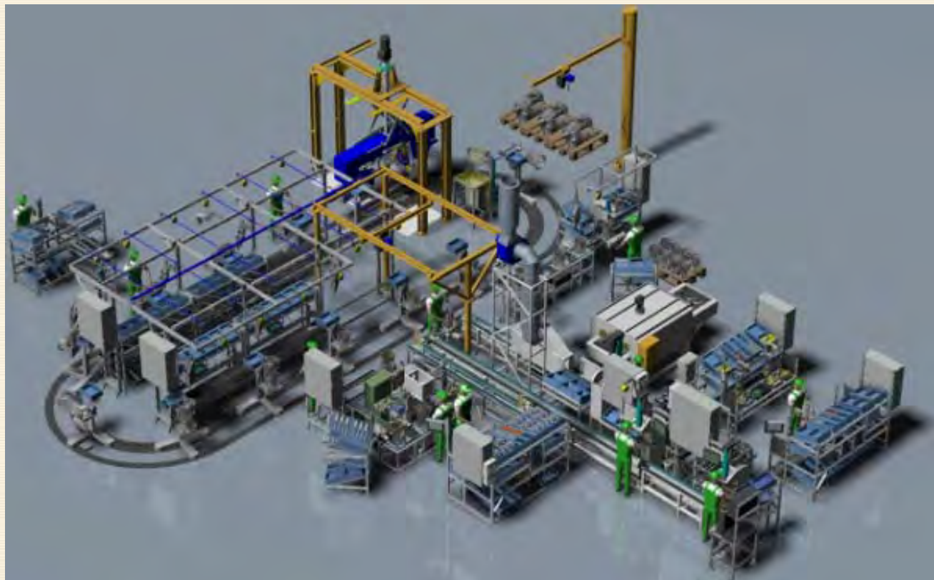
Fig.4.11. Linie de asamblare utilizând un layout mixt (progresiv și buclă) instalată în Brazilia în 2008 [w.del_17]
