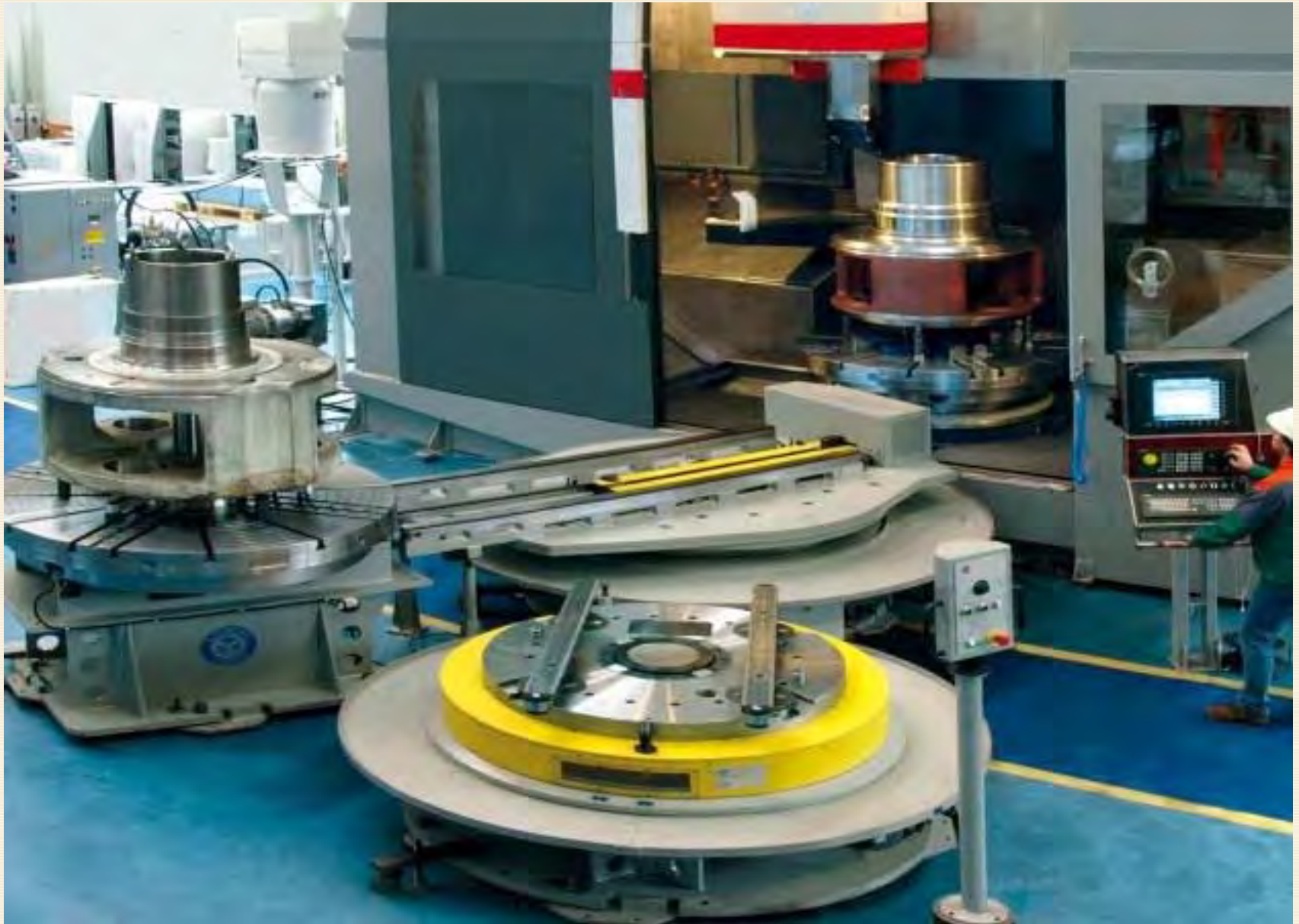
Fig.6.7. Sistem de transfer a paletelor pentru centre de prelucrare [w.dir_17/1]
