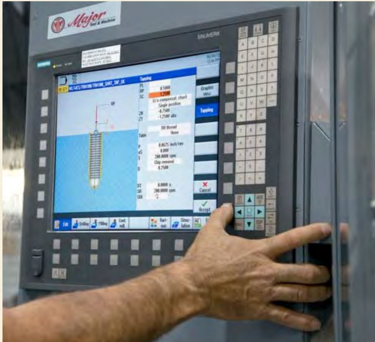
Fig.6.15. Programare conversațională [w.ber_17]
