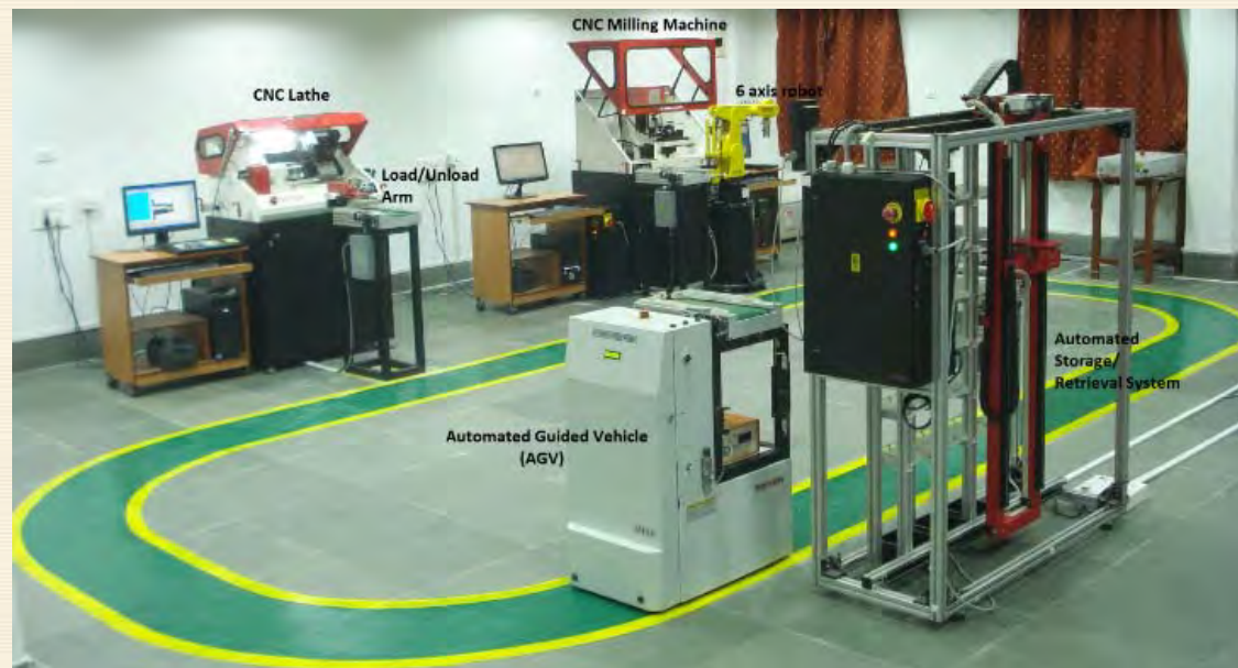
Fig.3.11. Linie flexibilă de fabricație: a) industrială, b) de laborator, cu caracter didactic sau experimental
