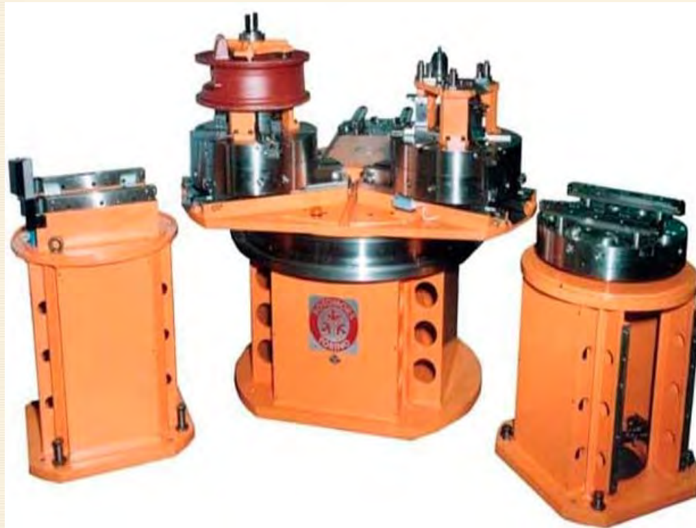
Fig.6.8. Exemple de sisteme schimbătoare de palete [w.dir_17/2]
