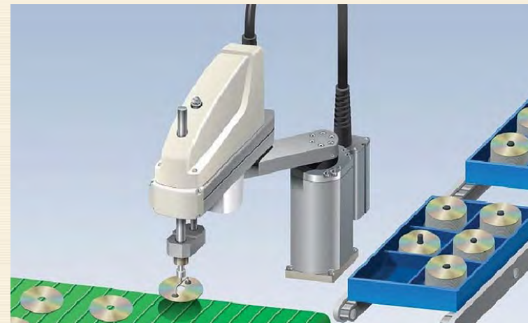
Fig.6.51. Roboți SCARA a) [w.ien_17], b) [w.ass_17]
