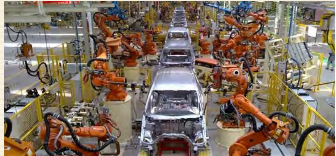
Fig.6.53. Roboți articulați a) individual [w.dir_17], b) linie robotizată [w.sol_17]
