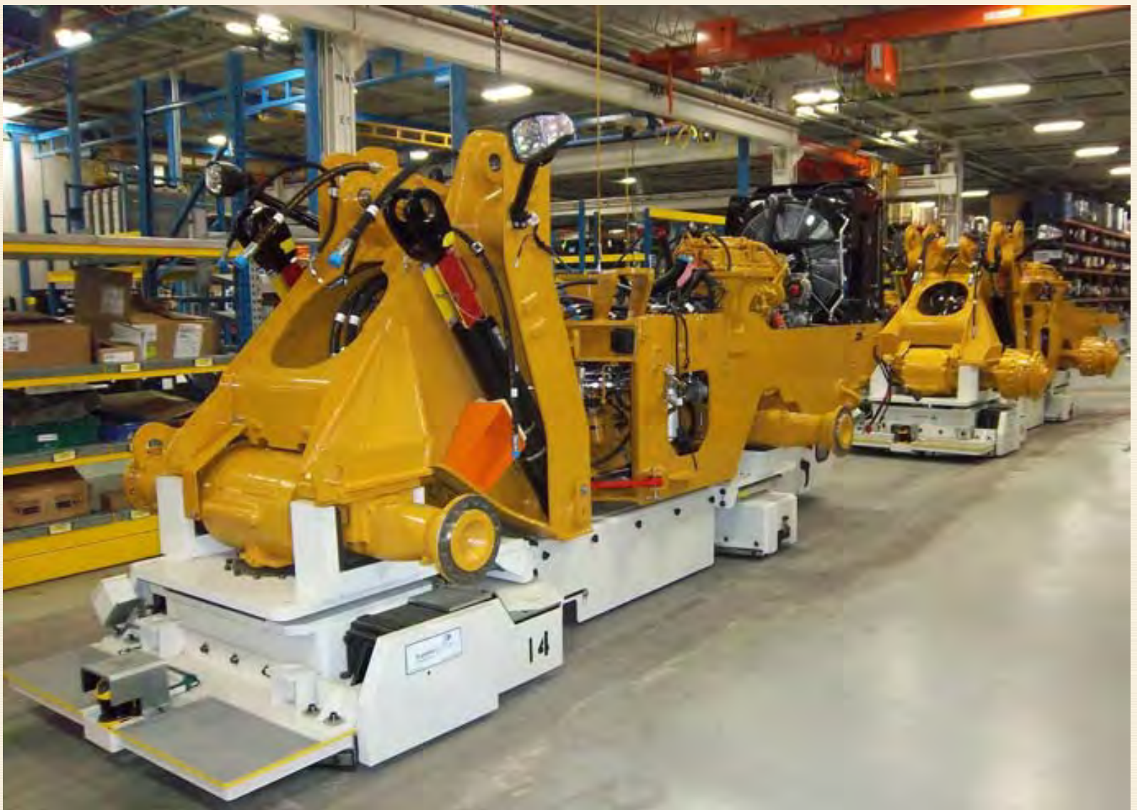
Fig.6.32. Ghidarea unui AGV prin cablaj activ[w.goo_x]
