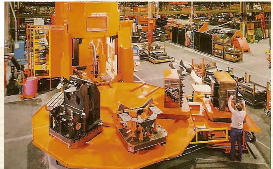
Fig.6.16. Celulă de fabricație cu o singură MU [w.stu_17]
