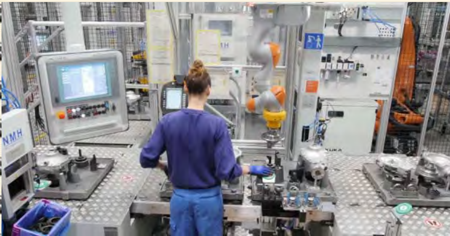
Fig.4.16. Linie de fabricație semiautomată a) pentru prelucrare [w.foo_17], b) pentru asamblare [w.muh_17]
