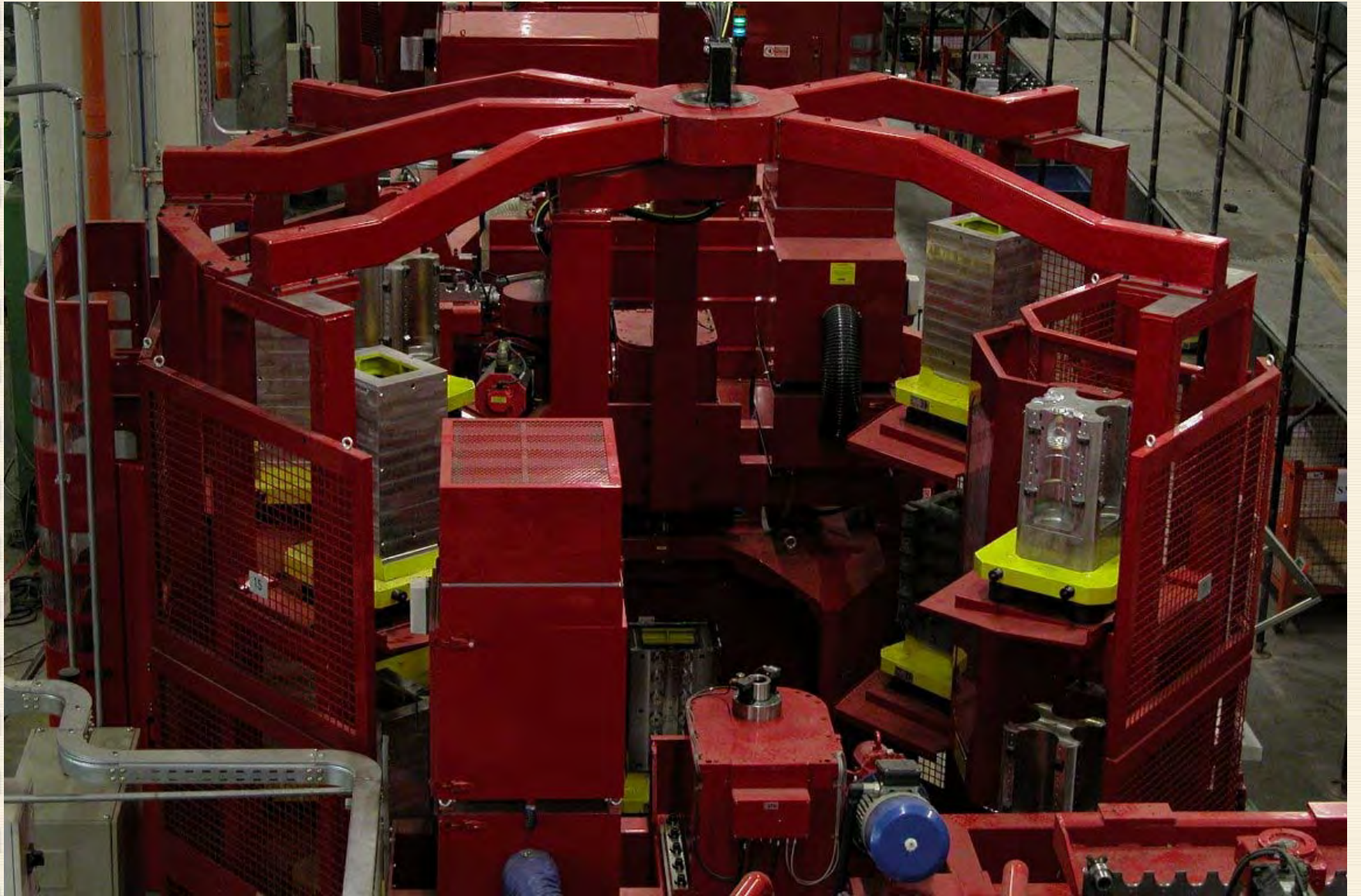
Fig.3.10. Vedere parțială dintr-o celulă flexibilă [w. dir_17]
