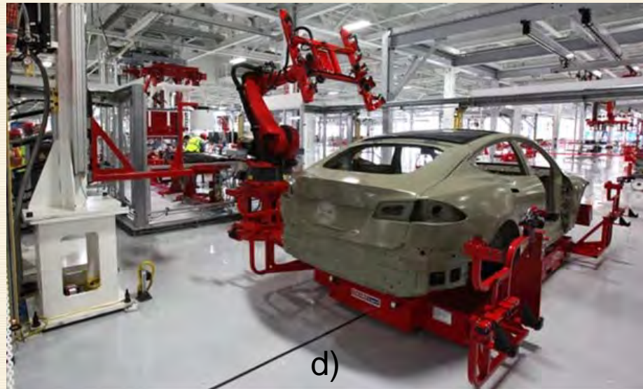
Fig.6.29. Exemple de aplicații a AGV-urilor a) [w.bar_17, b) [w.ass_17], c) [w.agv_17], d) [w.goo_15]
