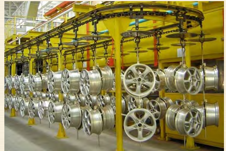
Fig.6.28. Conveiere suspendate a) [w.ove_17], b) [w.pin_17]
