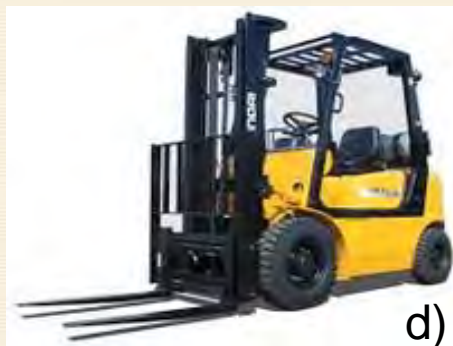
Fig.6.19. a) Transpalet [w.lif_17], b) stivuior [w.lif_17], c) cărucior [w.han_17], d) electrostivuior [w.com_17], e) cărucior de mână [w.han_17]
