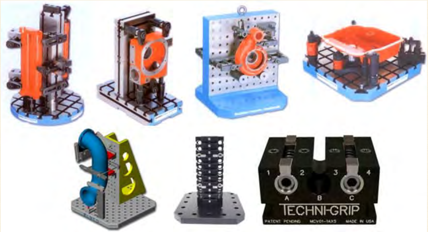
Fig.6.43. Utilizarea paletelor pentru fixarea diverselor piese [w.hal_20]
