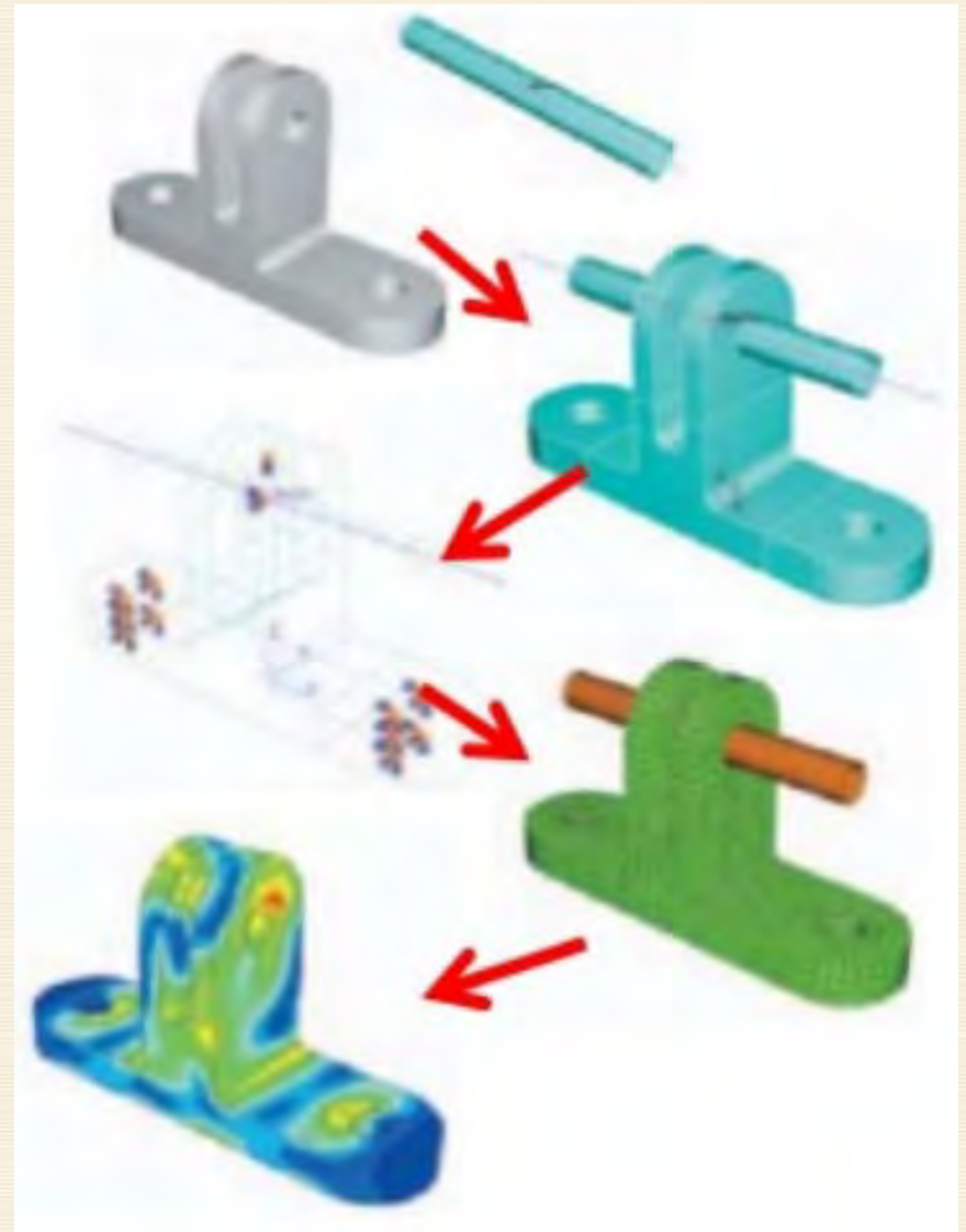
Fig.2.8. Analiza tensiunilor [w.goo_16]
