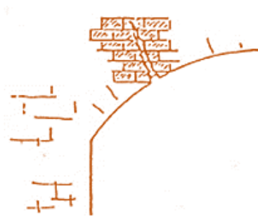
Fig. 3.76 Reparații cu strepi din cărămidă [13]
