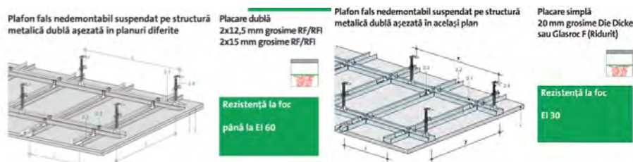
Fig. 3.27 Detalii de realizare a tavanelor false [129]
