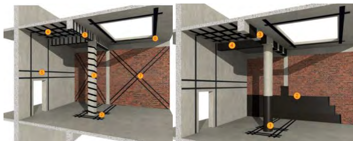
Fig. 3.93 Consolidări structurale cu materiale compozite Sika CarboDur și SikaWrap [135]
