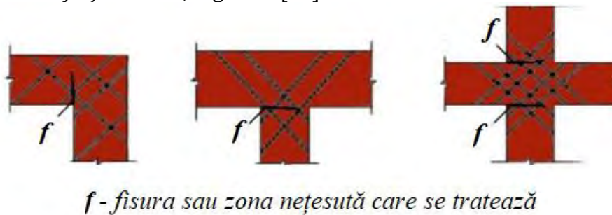
Fig. 3.51 Injectii armate la colțuri, ramificații și intersecții [19]
