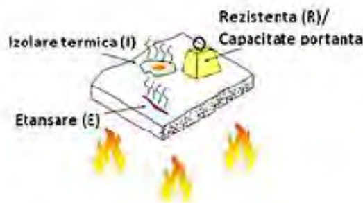
Fig. 3.25 Performanța elementelor de construcție privind rezistența la foc, apreciată prin criteriile R,E,I [110]
