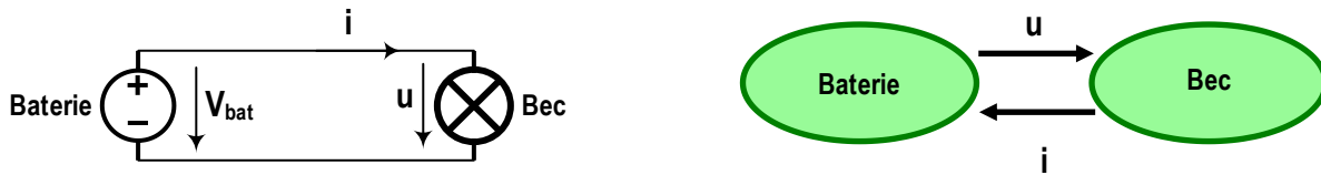
Fig. 2. Circuit baterie-bec (stânga) și modelul EMR aferent (dreapta)
