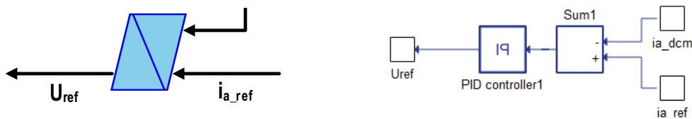
Fig. 40. Inversarea blocului de acumulare pentru determinarea tensiunii de referință a indusului
