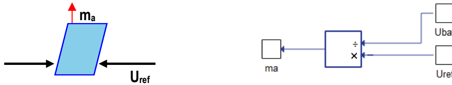
Fig. 41. Inversarea blocului convertor pentru determinarea indexului de modulare m_a
