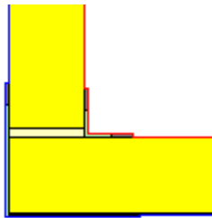
Fig. 3.6 Detaliu modelare geometrică îmbinare între panouri de perete - la colț
