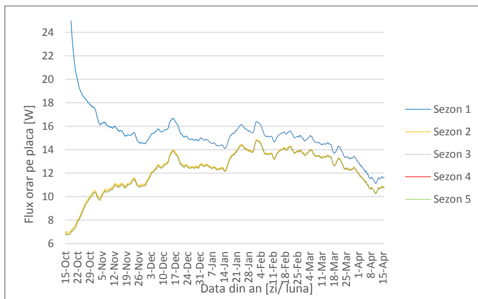
Fig. 4.23 Variația pierderilor de căldură spre sol pe durata a 5 sezoane de încălzire ColtPlaca_30x30 m_Simil 1:10 – după inițializare model numeric de tip “preîncălzire” sol
