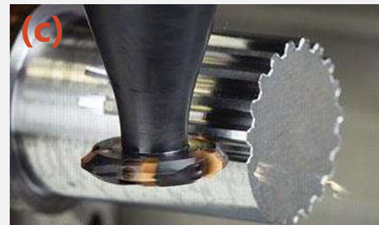
Fig. 4.9 Tehnologia de prelucrare a arborilor canelați (b), (c), (d) frezare [21], [22], [23]; (e) formare axială la rece [24];
