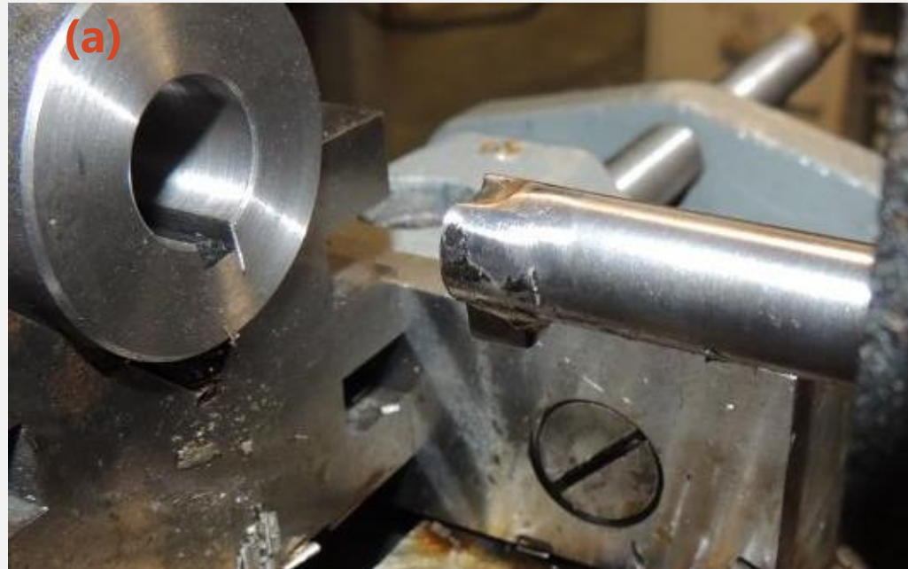
Fig. 4.4 Canalul de pană din butuc (a) mortezare [18]; (b) broșare [19]
