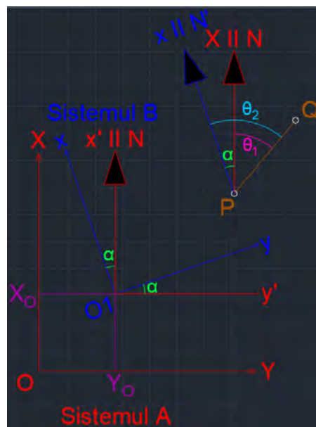
Figura 2. Determinarea unghiului de rotire
