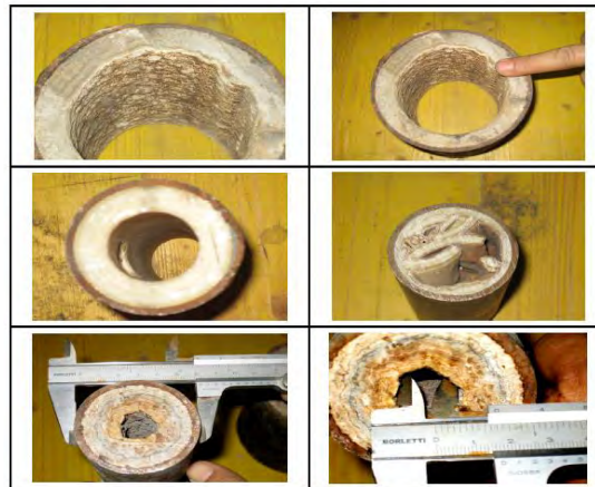
Figura 1 Depuneri de calcar in conducte [3]
