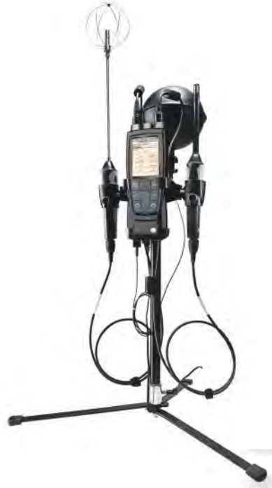
Fig. 4 – Echipamentul de monitorizare climatic Testo 480
