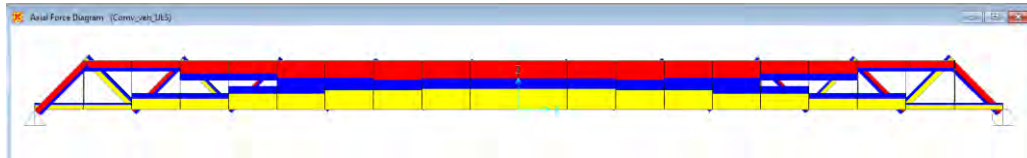
Figura 8. Diagrama din combinația de încărcări din vehiculul de serviciu
