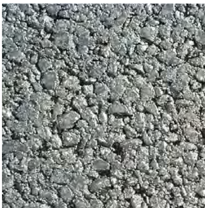
Figura 4. Asfalt cu matrice de piatră [17]
