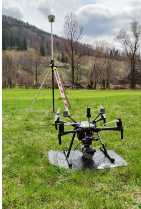
Figura 8. Drona și sistemul de poziționare GNSS pregătite pentru începerea misiunii de zbor.
