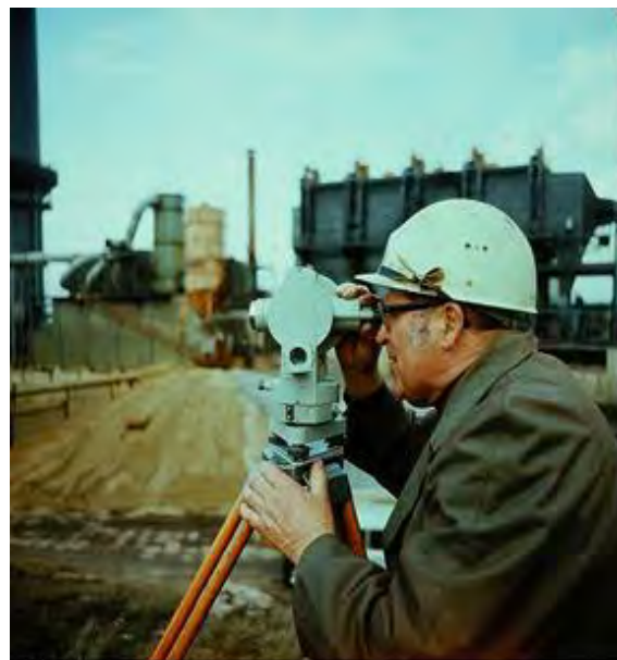
Fig. 2 Topograf lucrând cu un teodolit clasic
