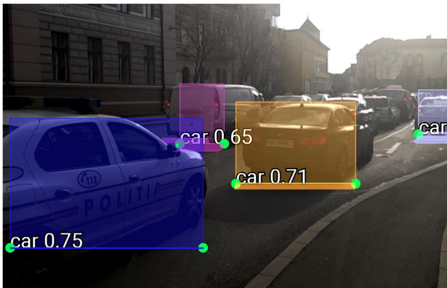
Figura 92. Detecția vehiculelor (captură de ecran direct de pe dispozitivul mobil).
