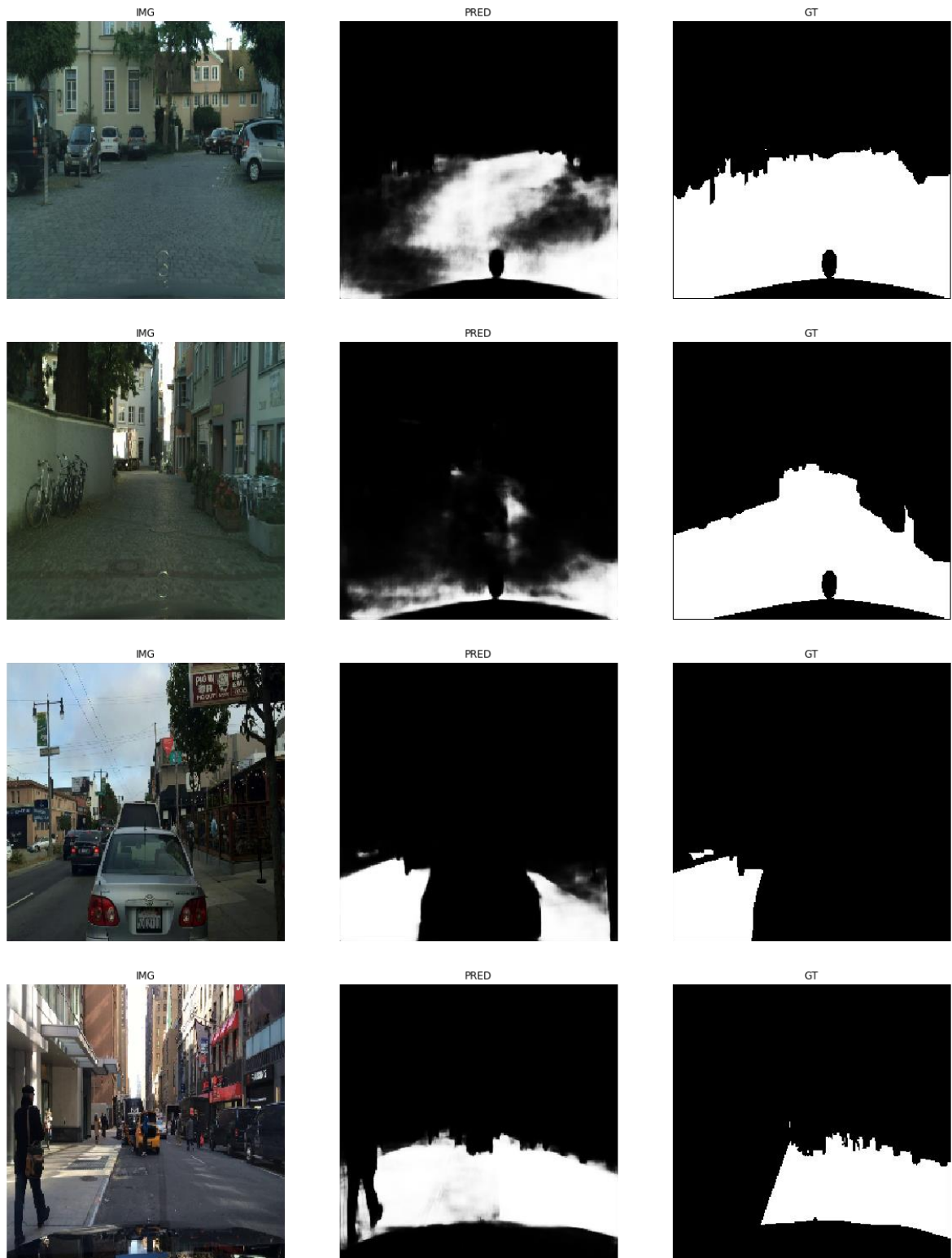
Figura 36. Exemplu de predicții eronate ale rețelei de segmentare. În centru este ilustrată predicția rețelei, iar în dreapta este imaginea “ground truth”. Sursă imagini: [Cordts2016], [Yu2018].
