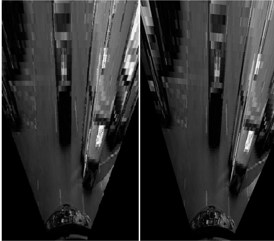
Figura 99. Comparație între imaginea IPM unde unghiul de rotație lateral este presupus a fi egal cu zero (stânga) și unghiul estimat corect (dreapta).
