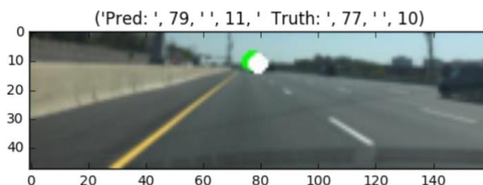
Figura 79. Exemplu de predicție de punct de fugă. Punctul verde reprezintă valoarea reală, iar punctul alb reprezintă predicția.
