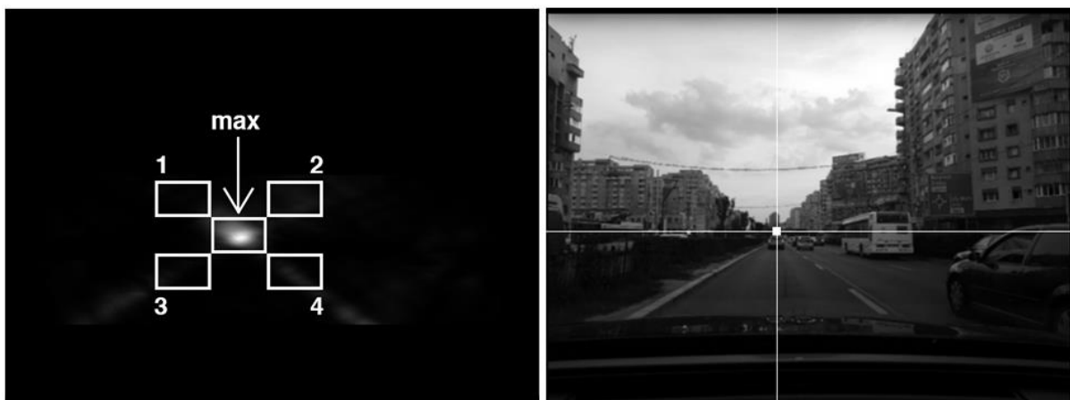
Figura 73. Stânga: ferestrele de votare alese pentru determinarea unui maxim. Dreapta: rezultatul final al algoritmului cu punctul de fugă calculat.
