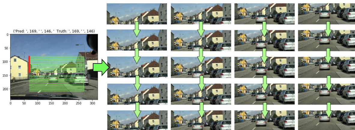
Figura 83. Tehnica "sliding window" pentru generarea noilor imagini de-a lungul axei X.
