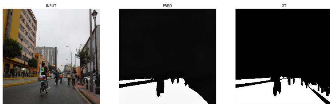
Figura 35. Exemplu de adnotare eronată în baza de date Mapillary în care zona de trotuar este marcată ca fiind zonă de drum (imaginea din dreapta). Sursă imagine: [Neuhold2017].
