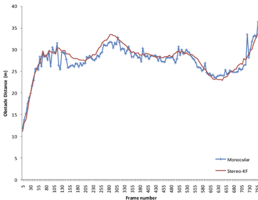
Figura 42. Comparare distanțe sistem propriu (monocular) vs. stereo-viziune. Axa verticală reprezintă distanța, iar cea orizontală reprezintă cadrul curent procesat.
