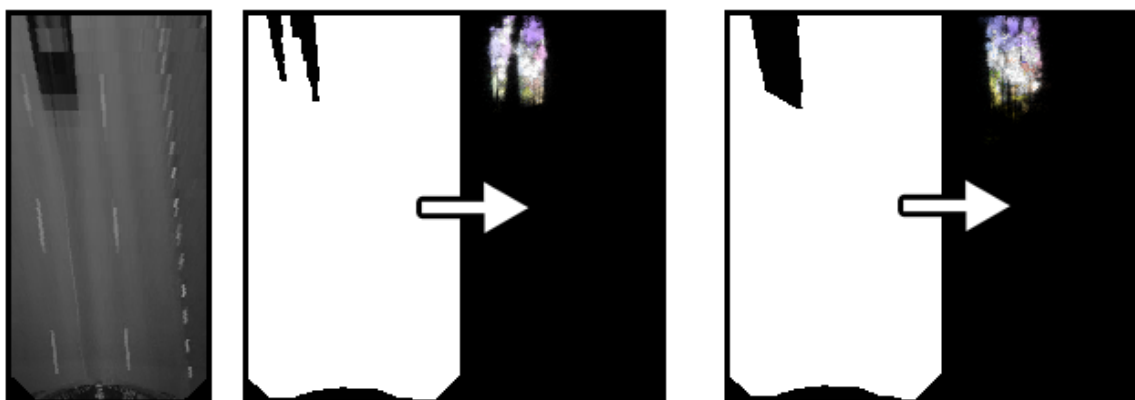
Figura 46. Îmbunătățirea hărții dinamice de ocupare. Perechi de imagini cu particulele generate în funcție de imaginea de măsurătoare (segmentată) utilizată.
