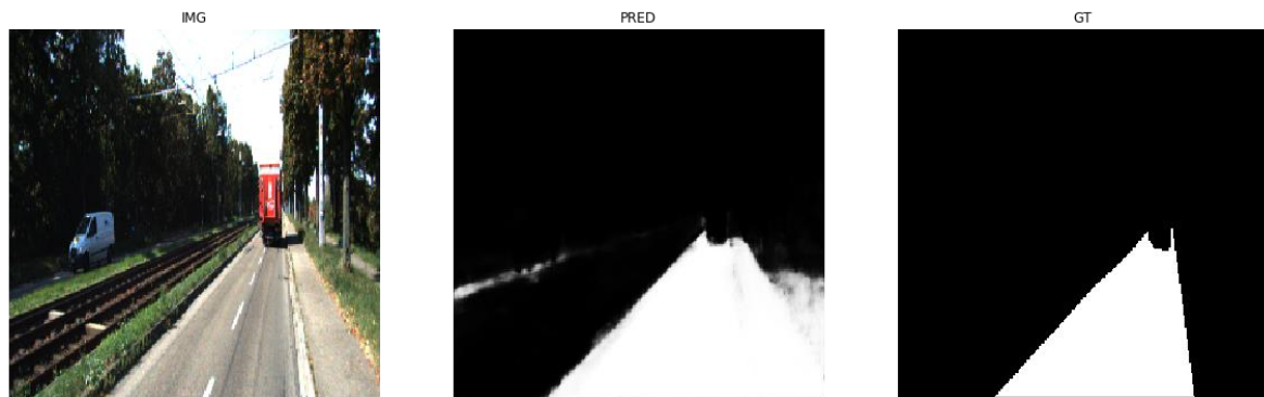
Figura 32. Rețeaua oferă predicție corectă și asupra zonei de drum de pe sensul opus, dar are dificultate cu zona de trotuar ce este clasificată greșit. Sursă imagini: [Geiger2012].
