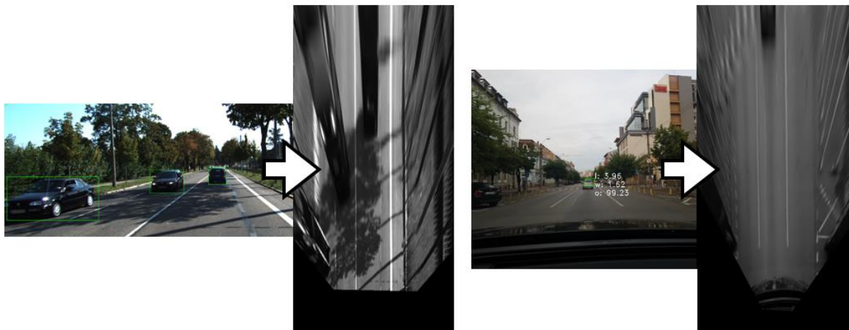
Figura 101. Generare imagini IPM folosind calibrarea automată.
