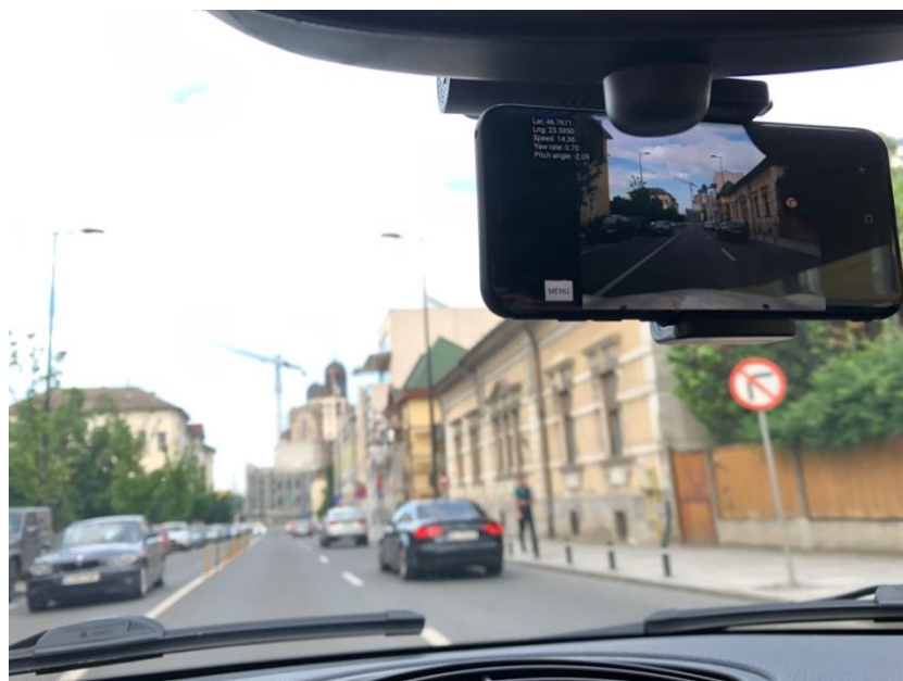
Figura 23. Modulul de achiziție bazat pe dispozitive Android.
