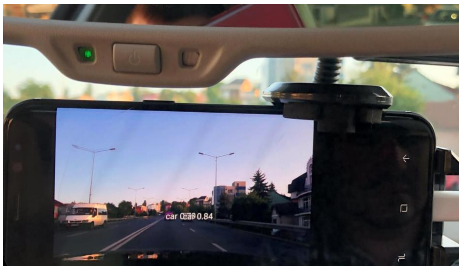
Figura 89. Dispozitivul mobil este poziționat în parbriz și detectează doar vehicule.
