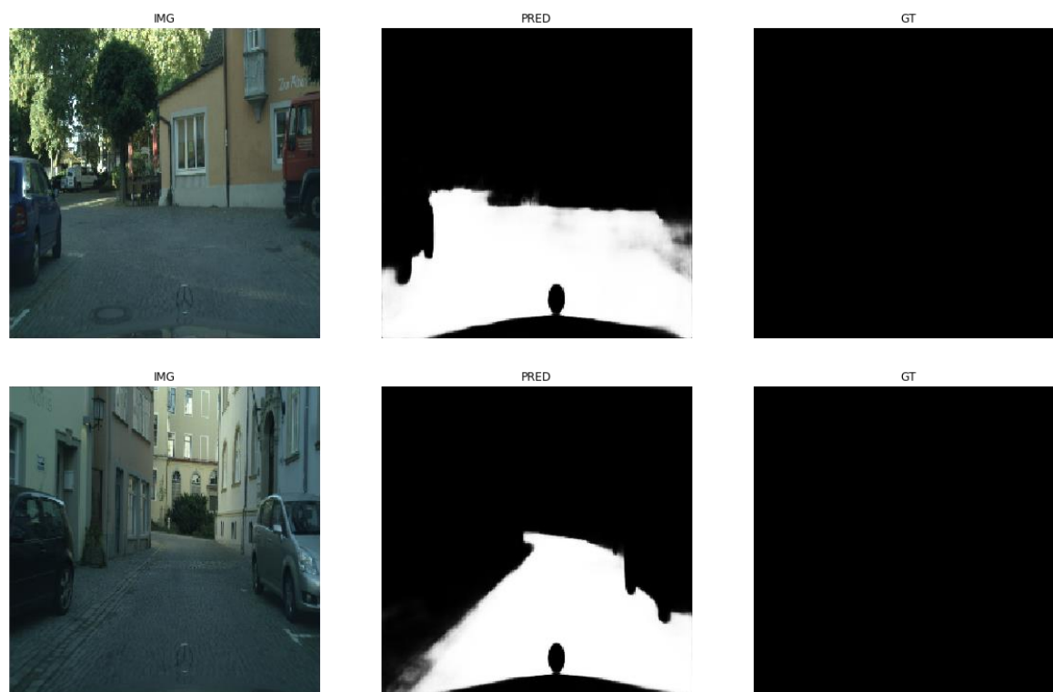
Figura 30. Exemple de imagini din setul de validare CityScapes în care adnotarea pentru drum nu este realizată (coloana din dreapta), iar rețeaua reușește să identifice corect zone de drum pe care se poate conduce (în centru) - vehiculele parcate confirmă faptul că zona poate fi considerată “driveable”.
