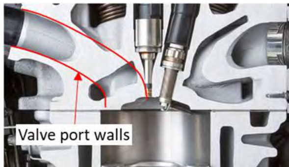
Fig. 1.26 Suprafețele utilizate pentru calculul transferului termic – canal admisie/evacuare
