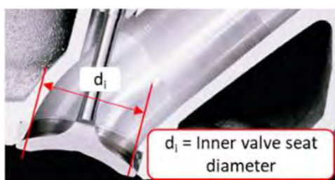
Fig. 2.28 Diametrul de referință pentru calculul curgerii prin orificiul oferit de supapă
