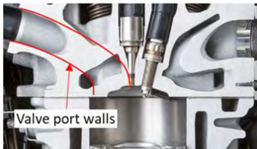
Fig. 3.52 Suprafețele utilizate pentru calculul transferului termic – Port
