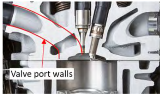
Fig. 2.25 Suprafețele utilizate pentru calculul transferului termic – Port
