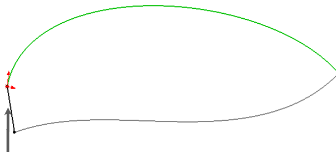
Schița 3D Nr. 2 conține doar curba Spline indicată în imaginea prezentată mai jos
