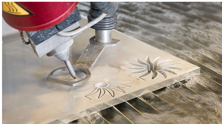
Fig. 3.53. Mașină de tăiat cu jet de apă cu 5 axe (Resato, n.d.)
