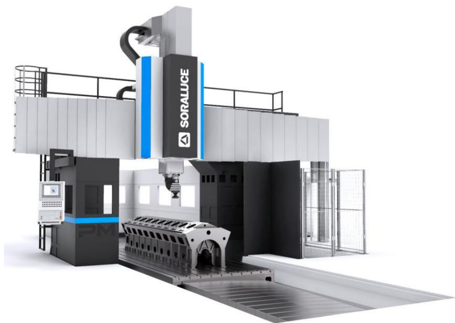
Fig. 3.14. Mașină de frezat cu portal (Soraluce, n.d.)
