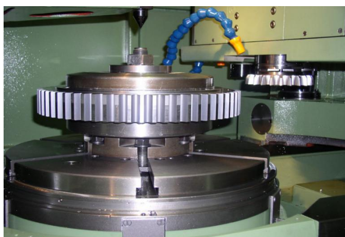
Fig. 3.39. Mortezaarea cu cuțit roată (TOS, n.d.)
