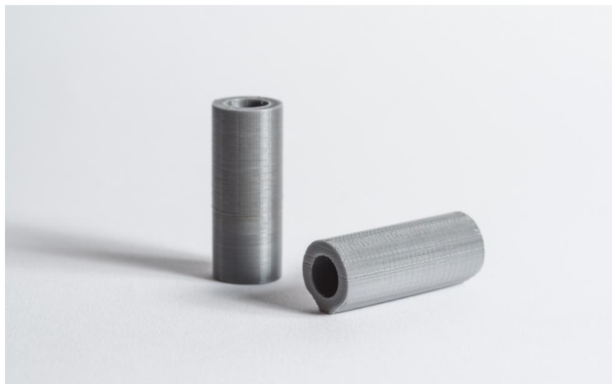
Fig. 3.66. Aceeași piesă realizată în diferite poziții prin FDM (Hubs, n.d.)
