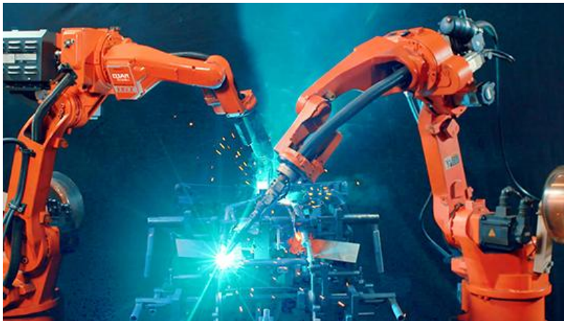
Fig. 4.2. Sudură cu ajutorul roboților (EVS, n.d.)
