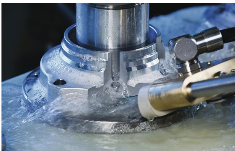
Fig. 3.59. Exemplu de prelucrare prin eroziune electro-chimică (Felix, 2012)
