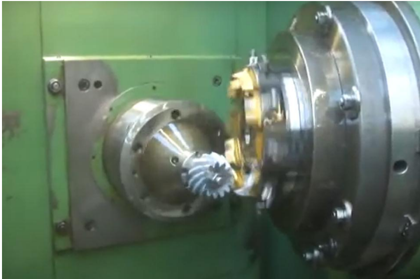
Fig. 3.49. Frezarea după metoda Oerlikon-Spiromatic (Google, n.d.)
