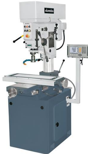
Fig. 3.3. Mașină de găurit în coordonate (Gillardon, n.d)
