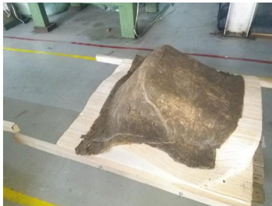
Fig. 9.10. Unul din prototipurile termoformate folosind matrița
