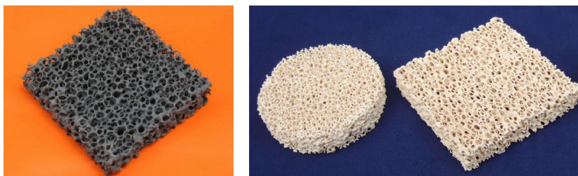
Figura 5.5 Mase ceramice poroase pe bază de a) SiC; b) MgO
