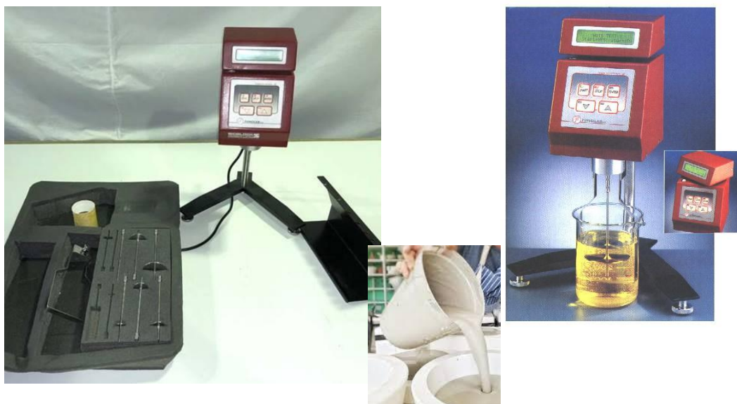
Figura 3.2 Vâscozimetru VISCO STAR R utilizat pentru determinările de vâscozitate
