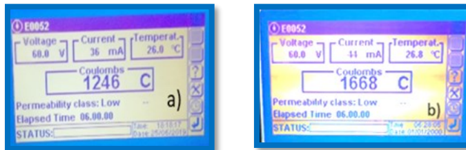
Figura 4-15. Sarcina înregistrată (Q) la 6 h, a) S 54/20, b) S 54/60 (imagini înregistrate cu aparatul marca Controls din laboratorul UTCN)
