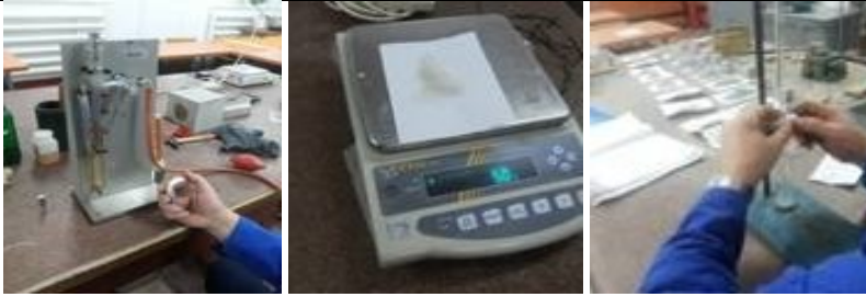
Figura 4-1. Imagini din laboratorul UTCN cu determinarea suprafeței specifice a pulberii de zgură
