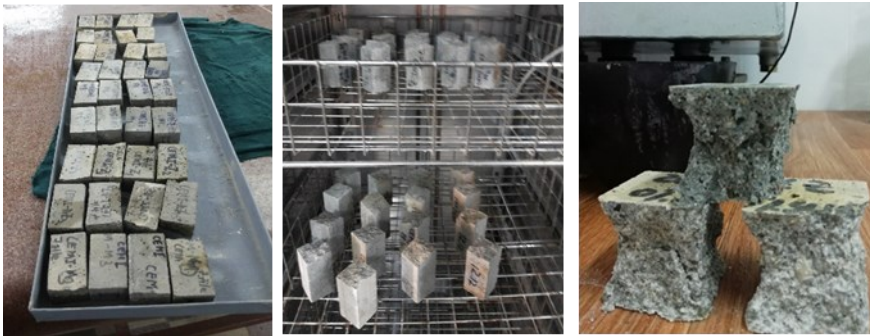
Figura 4-4. Determinarea rezistențelor pe mortare de ciment din zgură (imagini efectuate în timpul testului în laboratorul UTCN)
