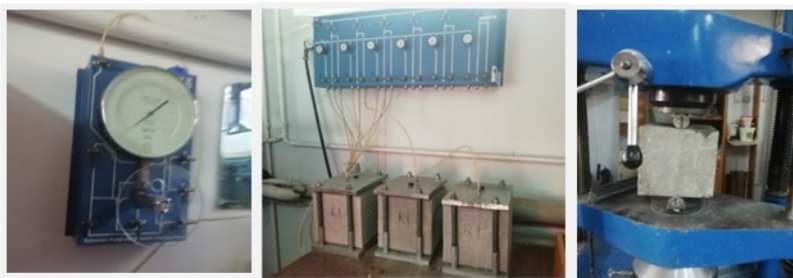
Figura 4-6. Determinarea adâncimii de penetrare a apei sub presiune (imagini din timpul testului din laboratorul UTCN)
