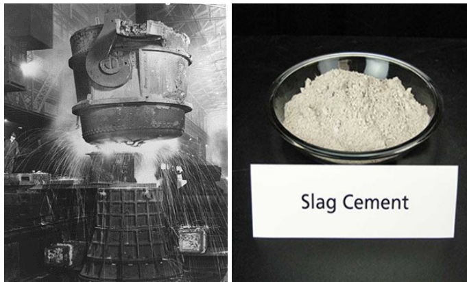
Figura 1-2. Imagini cu procesarea zgurii de furnal și ciment de zgură (GGBS) [24]
