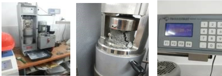
Figura 4-3. Presa hidraulică utilizată pentru determinarea rezistenței la întindere prin încovoiere (din laboratorul UTCN)
