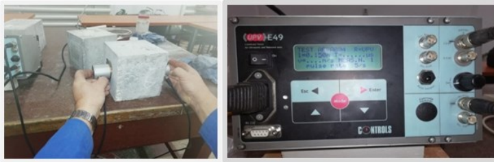
Figura 4-7. Măsurarea timpului de propagare a impulsurilor ultrasonice în beton (imagini din laboratorul UTCN)
