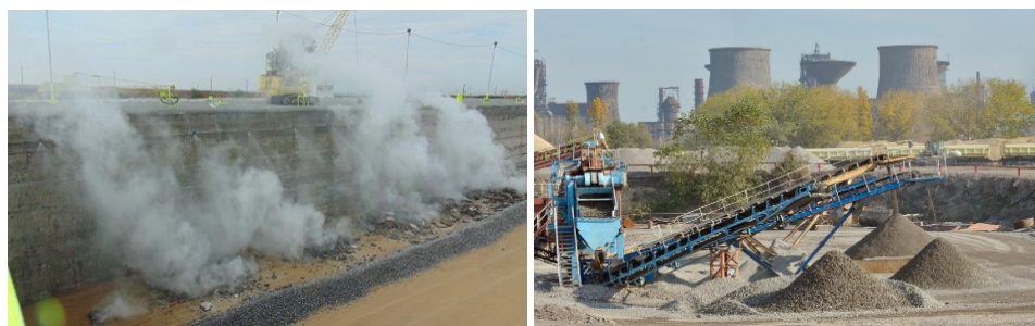
Figura 1-13. a) Solidificarea zgurii în aer, b) Concasarea zgurii negranulate la oțelăria din Galați (sursa imaginilor -de la producător)
