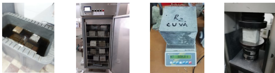
Figura 4-10. Epruvete martor menținute în apă și epruvete menținute la îngheț-dezgheț (imagini din laboratorul UTCN)
