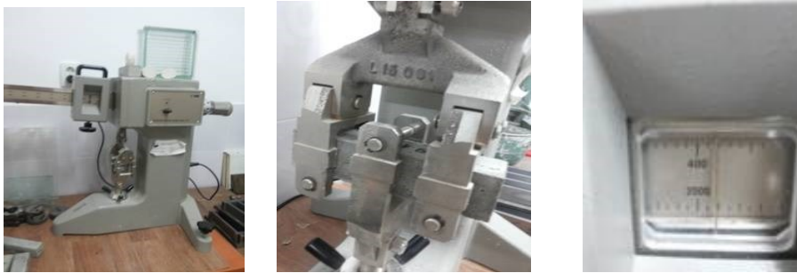
Figura 4-2. Imagini din laboratorul UTCN cu determinarea rezistenței la întindere din încovoiere pe mortare cu zgură
