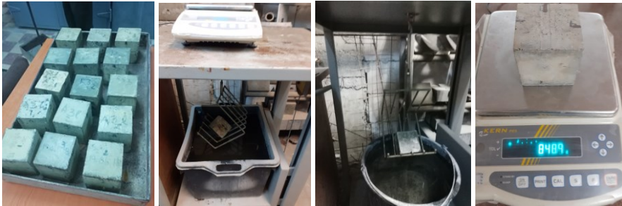
Figura 4-12. Cântărirea hidrostică a cuburilor cu latura de 71 mm (imagini din laboratorul UTCN)
