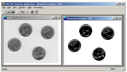
Fig. 2.4 Thresholding
