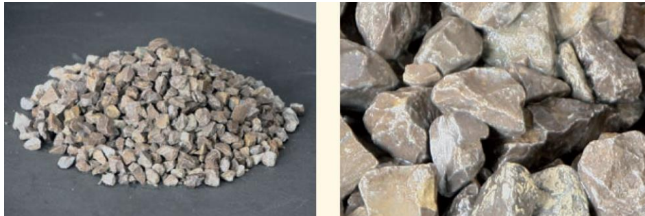
Agregate de concasare (cribluri și splituri) din granule de formă colțuroasă
