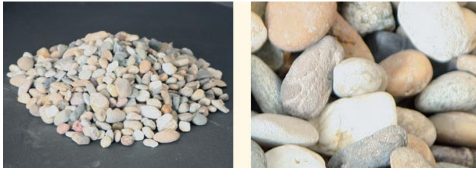
Agregate de balastieră din granule de formă rotunjită
