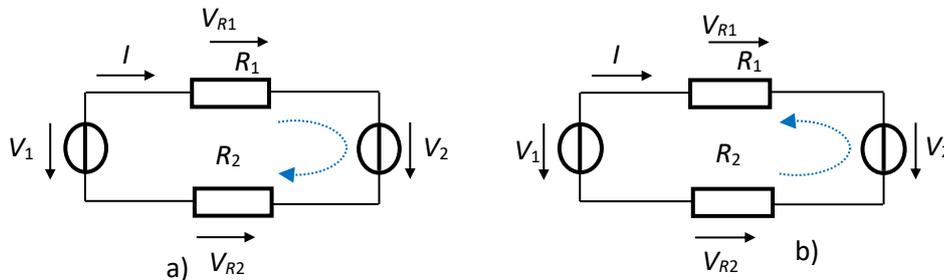
Fig.1.7. Illustration of KVL
