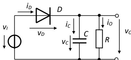
Fig.2.59. *DRC* rectifier
