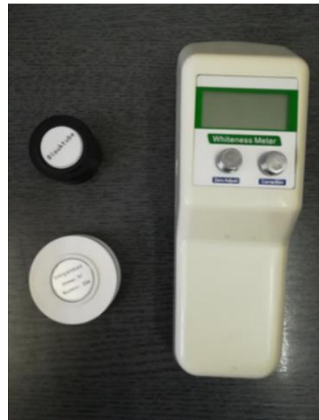
Fig. 5.5. Leucometru portabil tip WSB-1
