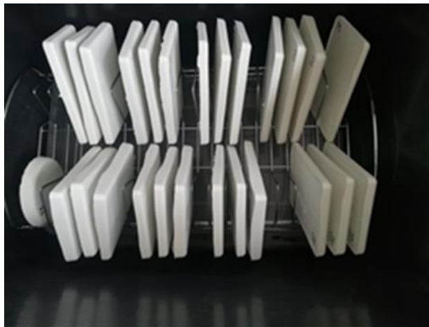
Fig. 5.1. Epruvete material compozit cu nanoparticule de \text{TiO}_2
