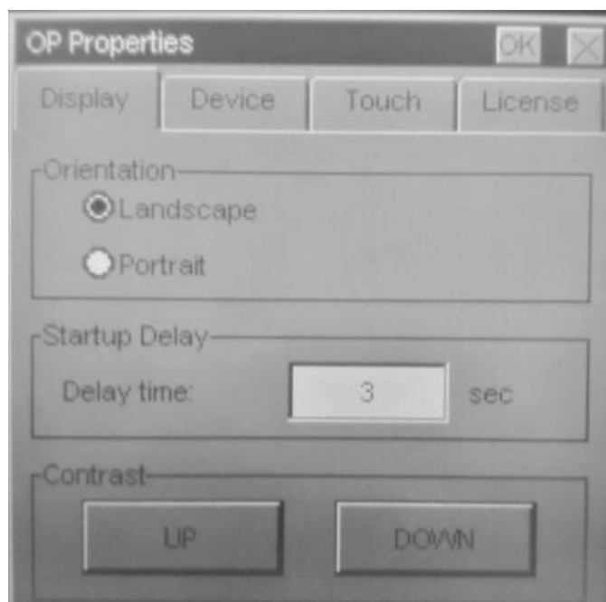
Figura II-24. Proprietăți specifice afișării și vizualizării informațiilor pe interfața om-mașină
