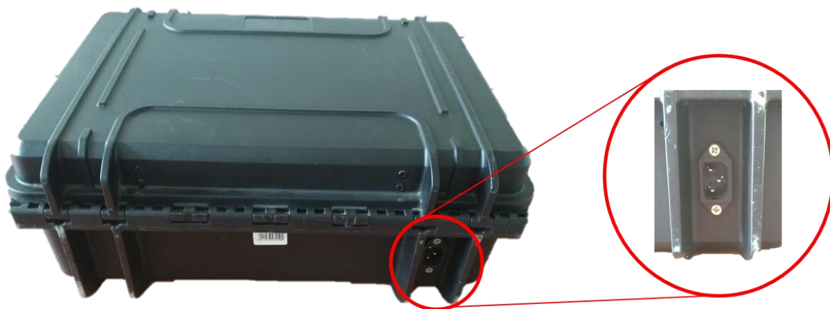
Figura 0-2. Punct de alimentare stand aplicații generale de automatizare
