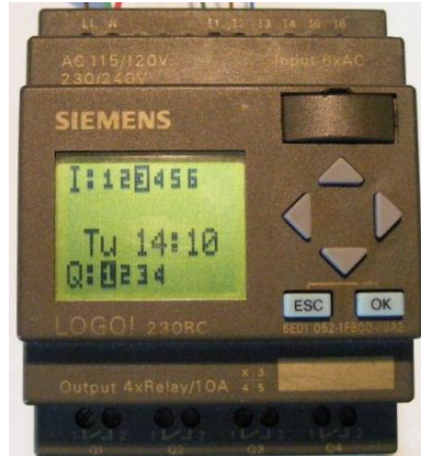
Fig. 2.25 – Ecranul Logo! când Q1 datorită îndeplinirii condițiilor din funcția SAU
