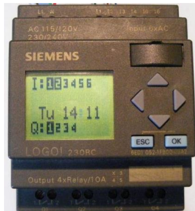
Fig. 2.24 – Ecranul Logo! când Q1 este activă datorită îndeplinirii condițiilor din funcția ȘI
