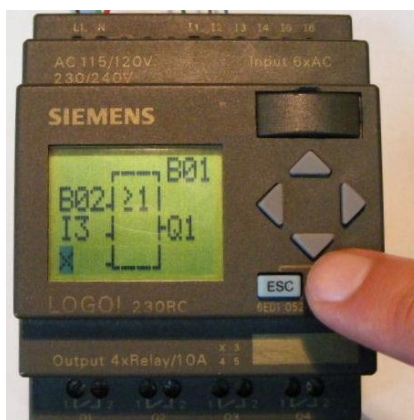
Fig. 2.22 – Confirmarea finalizării programului prin apăsarea tastei OK
