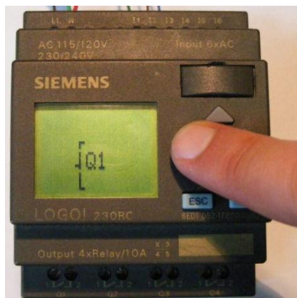
Fig. 2.18 – Alegerea ieşirii Q1 ca ieşire pentru program
