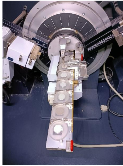
Fig. 3.3. Mod de poziționare epruvete pentru testare în difractometru de raze X, Bruker D8 ADVANCE
