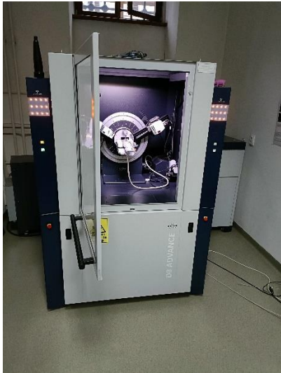
Fig. 3.2. Imagine de ansamblu a difractometrului de raze X, Bruker D8 ADVANCE
