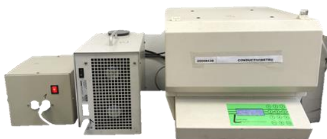
Fig. 5.77. Conductivimetru Tip Fox 314
