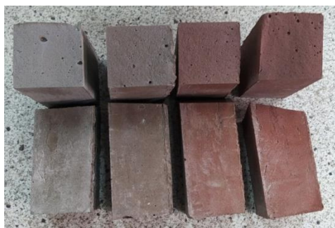
Fig. 5.50. Lianți ecologici activați alcalin după determinarea rezistenței la întindere prin încovoiere
