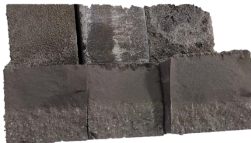
Fig. 5.46. Liantul ecologic R20 cu dispunerea prafului de marmură în cantitate mai mare la partea inferioară a epruvetei
