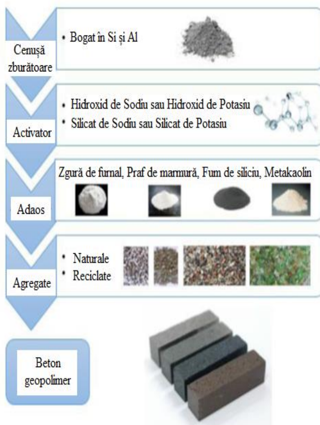
Fig. 2.7. Materii prime și principalii activatori alcalini pentru realizarea betonului geopolimer
