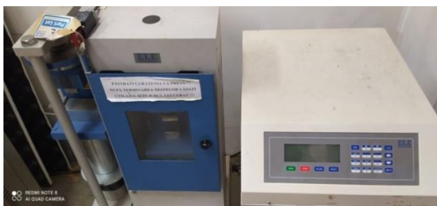
Fig. 5.11. Mașină de încercare a rezistenței la încovoiere și la compresiune, de tip digital
