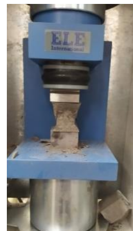
Fig. 5.15. Epruvete după determinarea rezistenței la compresiune
