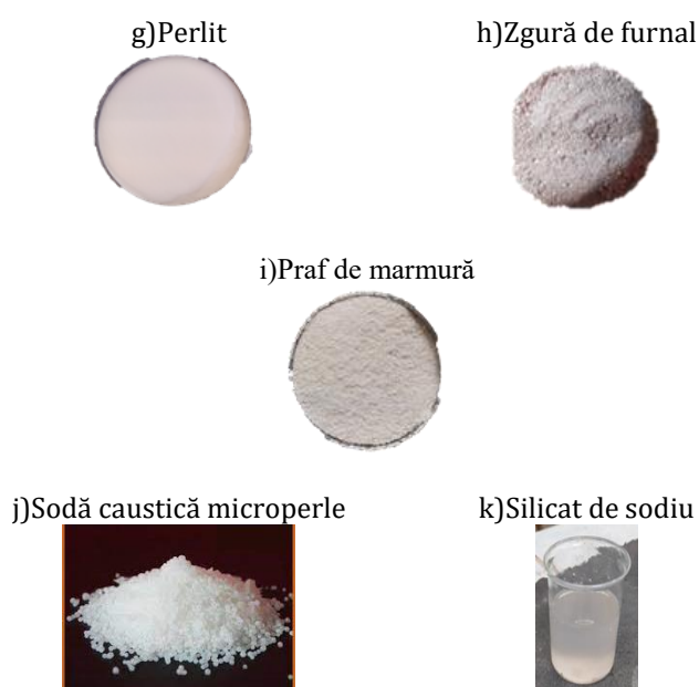
Fig. 5.5. Materii prime utilizate la realizarea lianților ecologici activați alcalin
