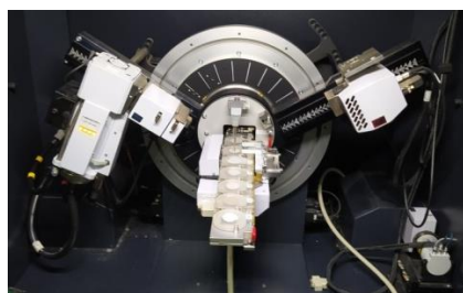
Fig. 6.17. Pulberi din materii prime și microbetoane geopolimere activate alcalin supuse difracției cu raze x
