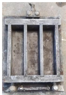
Fig. 5.7. Tipar metalic 3x(40x40x160)mm
