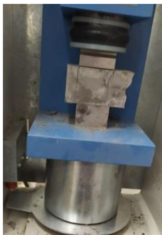
Fig. 5.14. Mod de încercare al epruvetelor pentru determinarea R_c
