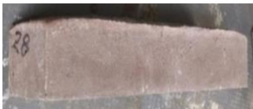
Fig. 5.31. Liantul ecologic R28 la vârsta de 7 zile
