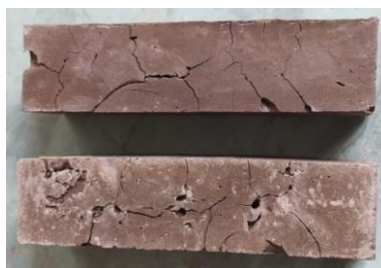
Fig. 3.34. Liantul ecologic R47FTT la vârsta de 7 zile
