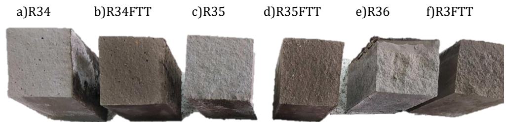
Fig. 5.68. Epruvete din liant ecologic cu diferite substituții cu și fără tratament termic
