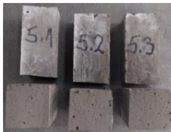
b) Aspect epruvete R5 (NaOH-10M) după rupere prin solicitare la încovoiere
