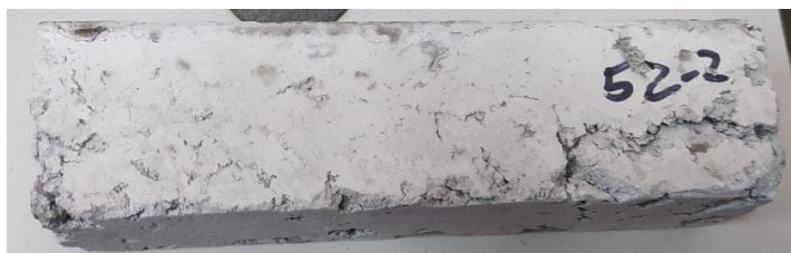
Fig. 5.36. Liantul ecologic R52 la vârsta de 14 zile
