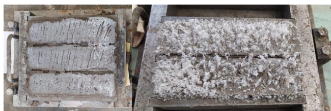
a) cu tratament termic, b) fără tratament termic Fig. 5.75. Liant ecologic pe bază de cenușă zburătoare și zgură de aluminiu
