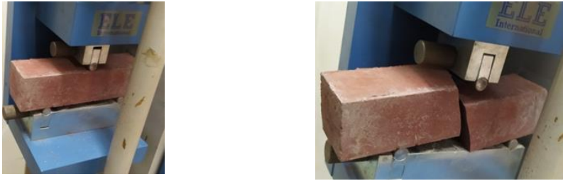
Fig. 5.49. Imagini din timpul determinării rezistenței la întindere prin încovoiere
