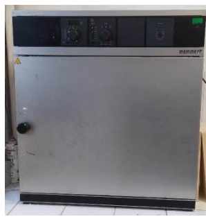
Fig. 5.8. Etuvă termoreglabilă ULM 500
