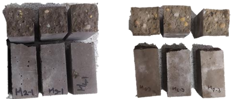
a) M2, M3, M4 cu tratament termic 70°C, 24h b) M5, M6, M7 fără tratament termic
