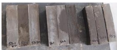
Fig. 5.25. Liant ecologic cu praf de marmură fără tratament termic la vârsta de 7 zile
