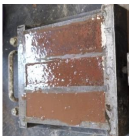
Fig. 5.30. Liant ecologic activat alcalin a) în stare proaspătă și b) după efectuarea tratamentului termic 24h, 70°C
