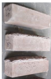
Fig. 5.30. Liant ecologic activat alcalin a) în stare proaspătă și b) după efectuarea tratamentului termic 24h, 70°C
