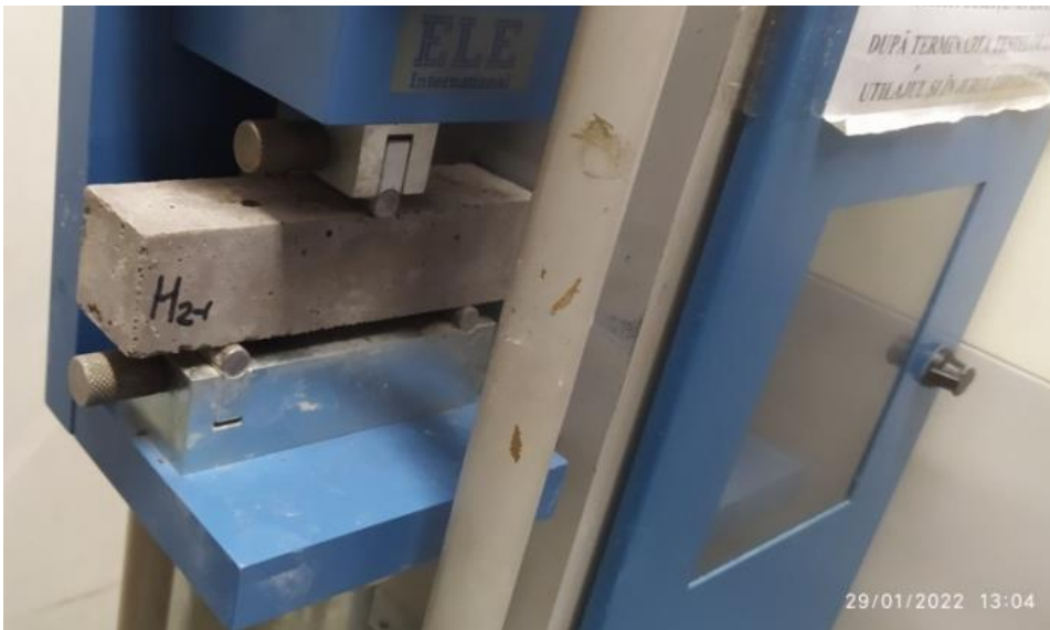
Fig. 6.9. Epruveta compoziției M2 în timpul determinării rezistenței la întindere prin încovoiere
