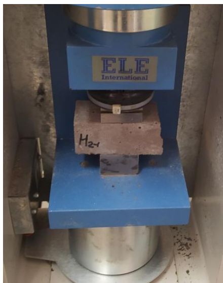
Fig. 6.13. Epruveta compoziției M2 în timpul determinării rezistenței la compresiune
