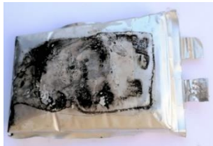
Fig. 3.111 Celula de tip pungă deformată prin străpungere cu vârf ascuțit
