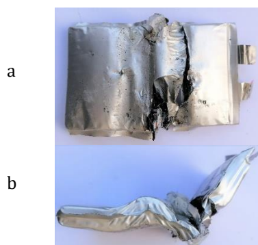
Fig. 3.99 Celula de tip pungă deformată prin încovoierea în trei puncte a – vederea din față; b - vederea laterală
