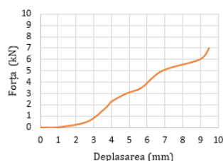
Fig. 3.90 Curba forță-deplasare pentru celula de tip pungă la deformarea cu vârf semirotund
