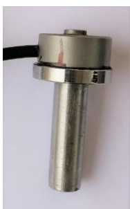
Fig. 3.3 Traductorul de forță
