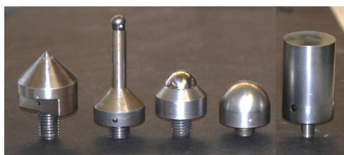
Fig. 2.19 Indentatoare utilizate în cadrul testului experimental De la stânga la dreapta fiind vârful 90° conic, vârful semirotond de 12.7 mm, 28.575 mm, 44.45 mm și vârful cilindric cu diametru de 25.31 mm cu capul plat [95]
