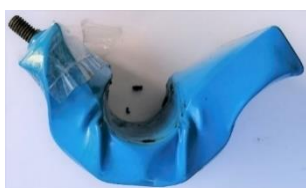
Fig. 3.98 Celula prismatică deformată prin încovoierea în trei puncte
