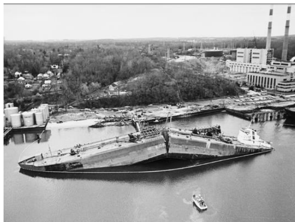
Fig. 79 Scufundarea navelor Liberty datorită temperaturii mari de tranziție ductil-fragil.
