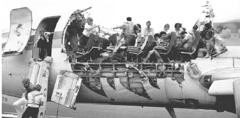
Fig. 225 Coroziune Selectivă Aluminiu: 1988, Boeing 737, Aloha Airlines [cited].
