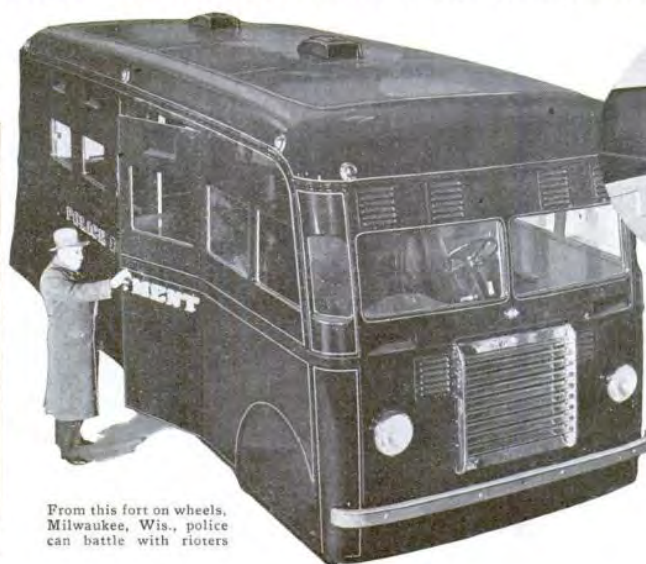
Fig. 235 Primul camion de Poliție dotat cu geam antiglonț, realizat din material compozit laminat, 1937 .
