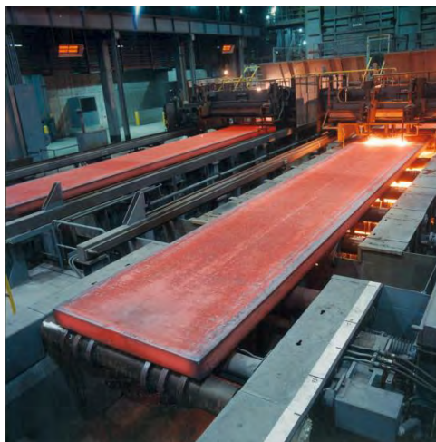
Fig. 93 Obținerea șleburilor prin turnare continuă și aplicații ale oțelurilor de înaltă rezistență (AHSS – Advanced High Strength Steels) în industria automotive.
