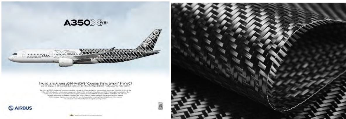
Fig. 39 Materiale compozite pe bază de polimeri ranforșați cu fibră de carbon, CFRP .
