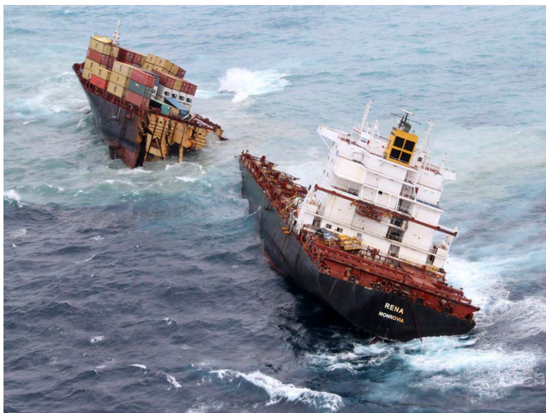
Fig. 18 Navă maritimă tip vas cargo ce a suferit o rupere catastrofală ca urmare a modificărilor proprietăților de material în urma proceselor de sudare [video] .
