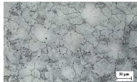
Nivel 2b: Fluaj avansat, apariția numeroasă de microcavități fără orientare preferențială
