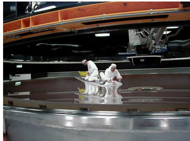
Fig.25 Oglindă diametru 8.2 m. Material Zerodur . Își păstrează caracteristicile dimensionale la variații de temperatură necesare pentru calitatea imaginilor.
