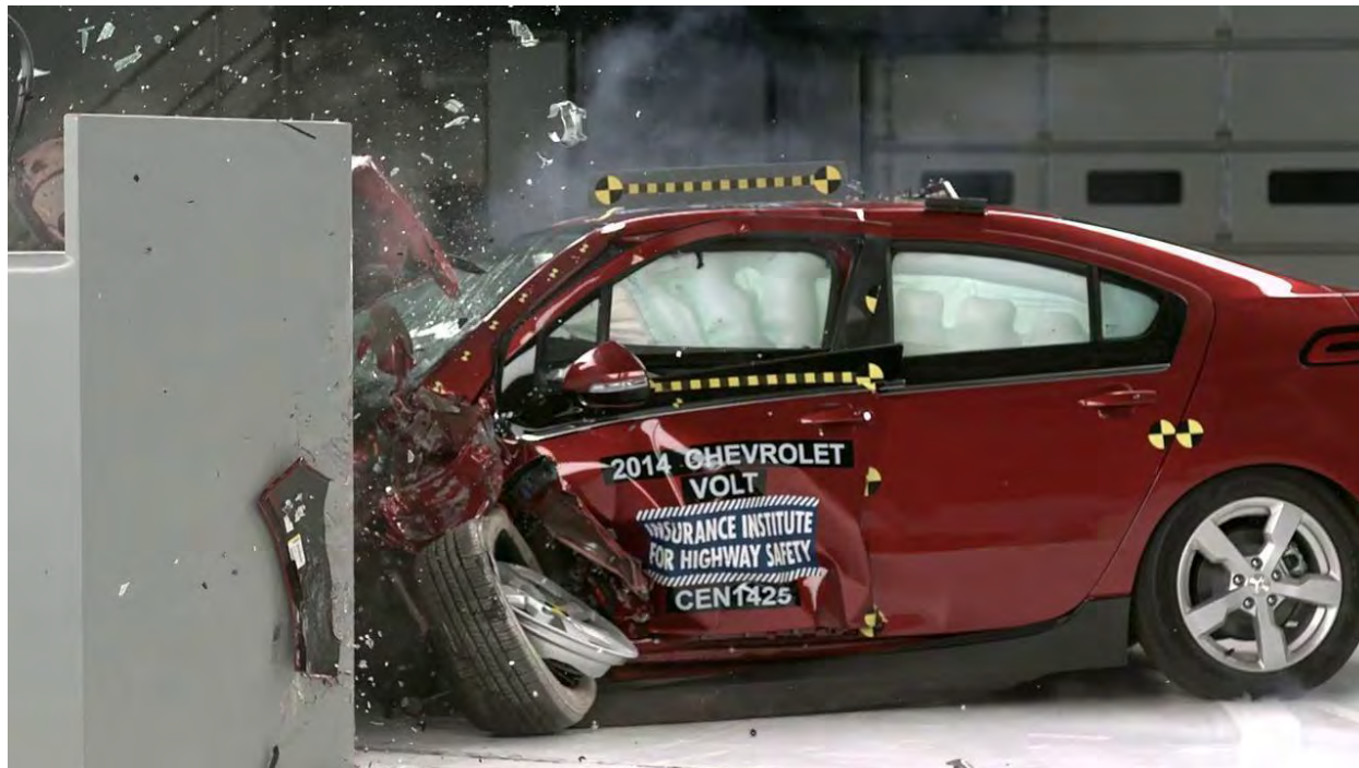
Fig. 11 Crash-test în industria automotive pentru evaluarea siguranței pasagerilor [movie].
