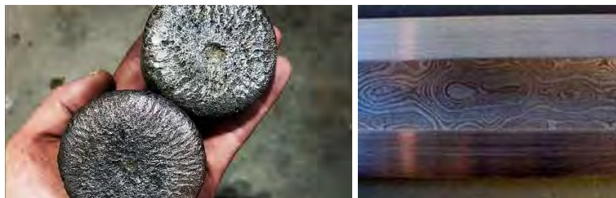
Fig. 6 Wootz Steel Ingots pentru obținerea oțelului de Damasc.
