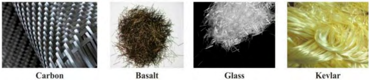
Fig. 230 Fibre sintetice pentru ranforsarea materialelor compozite.
