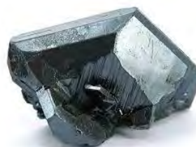
c) Calcocit \text{Cu}_2\text{S} , conține cca. 80% Cu
