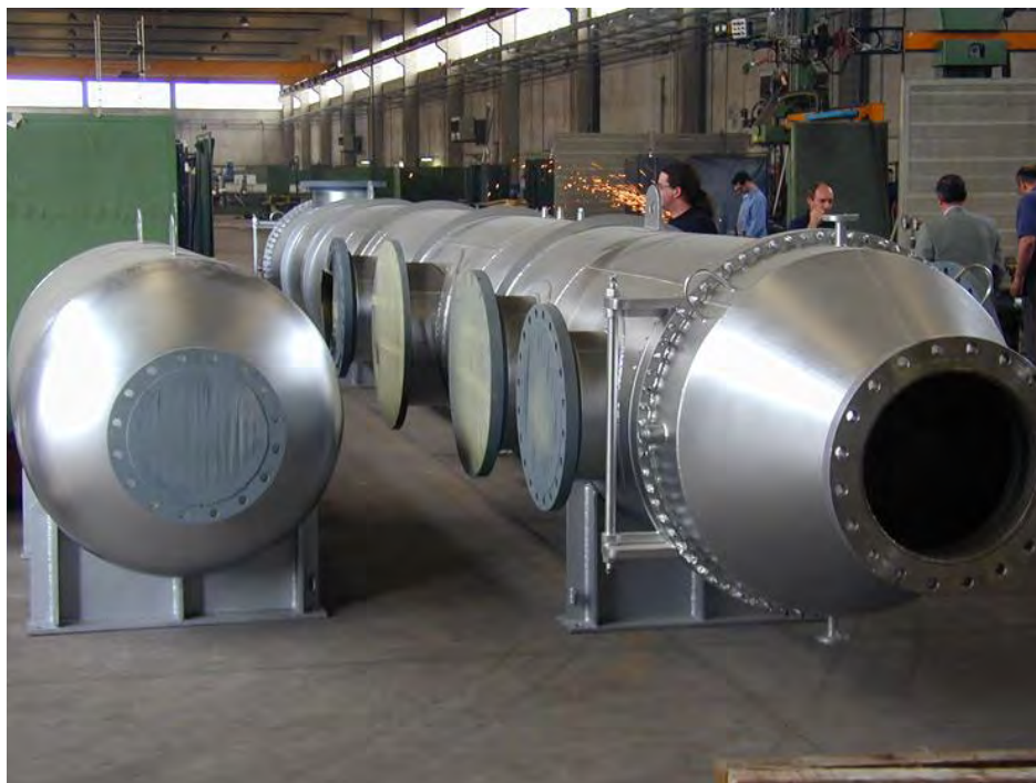
Fig. 198 Schimbătoare de căldură realizate din superaliaje [ aplicații ].
