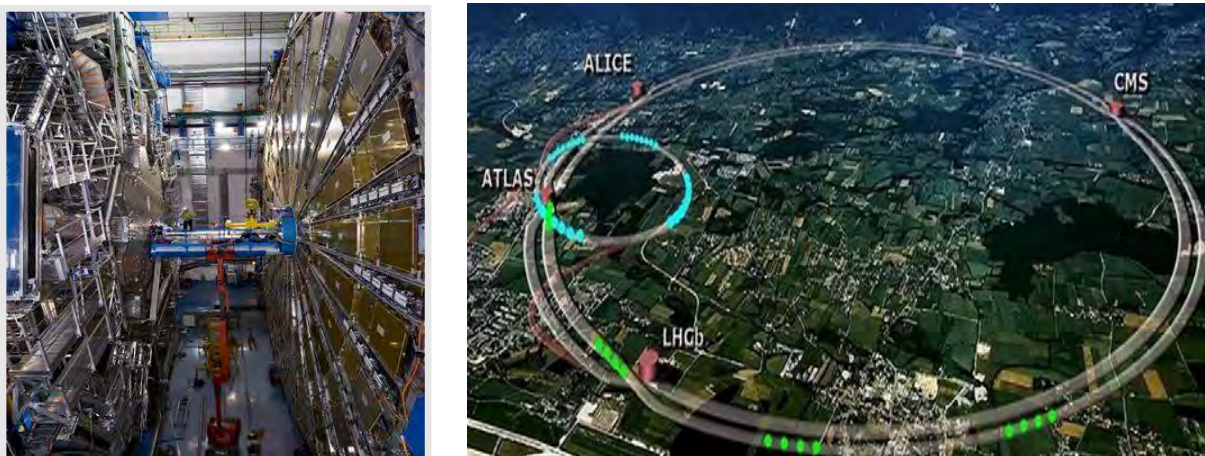
Fig. 46 Vedere detector și acceleratorul de particule Large Hadron Collider , situat la Geneva la granița dintre Franța și Elveția. Cercurile reprezintă tuneluri vidate îngropat la adâncimi de 45-175 m.
