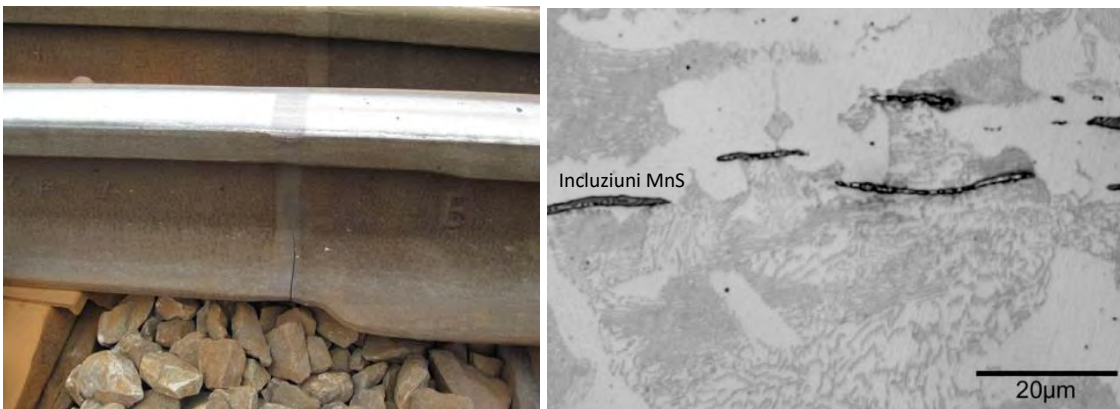
Fig. 138 Incluziuni nemetalice MnS în oțeluri și efectul lor asupra comportării oțelurilor în exploatare.
