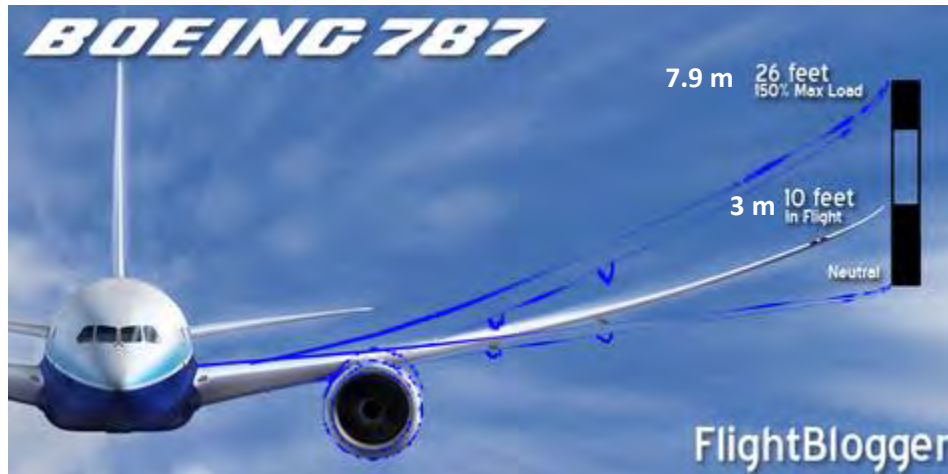
În zbor, aripile se pot curba 3 m ca urmare a susținerii greutatei avionului. La limită se pot curba cu 7.9 m Fig. 223 Flexibilitatea superioară a aripilor de avion Boeing 787 [22].
