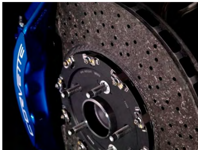
Fig. 232 Disc de frână de la Chevrolet Corvette, compozit carbon-ceramic [video].
