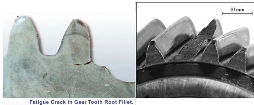
Fig.78 Rupere la oboseală mecanică datorată incluziunilor nemetalice de MnS [video] .
