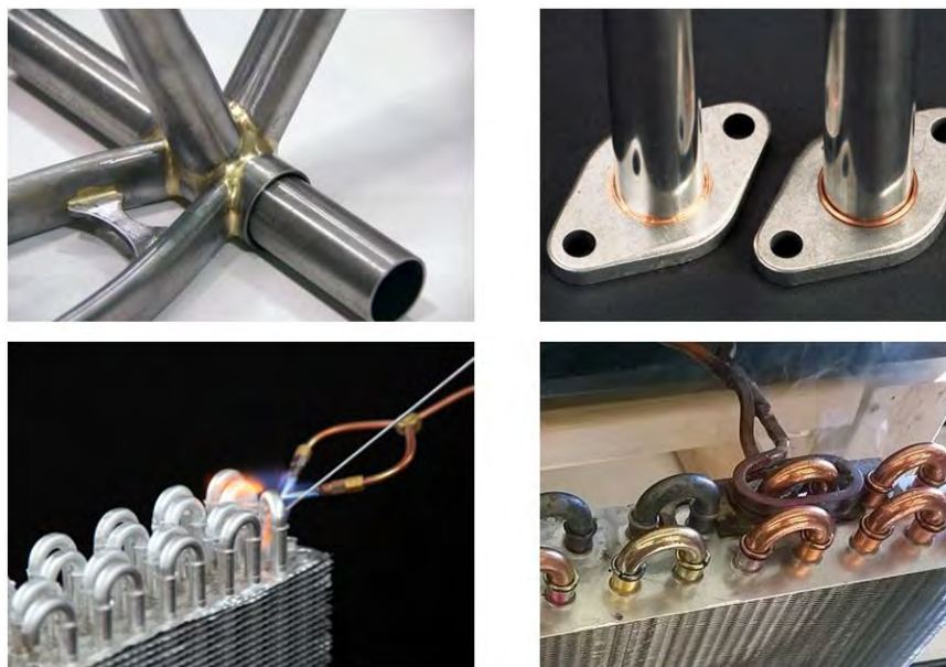
Fig. 162 Aplicații pentru aliaje de lipire tare, lipire radiatoare (cu baghetă din alamă).
