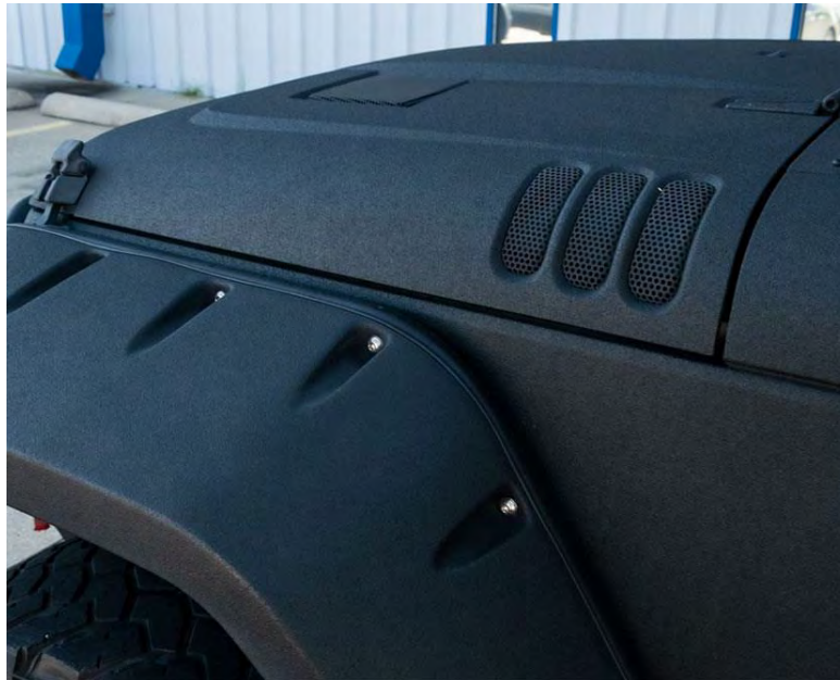
Fig.35 Elemente de caroserie realizate din kevlar. Se mai pot obține curele de transmisie, componente sistem de frânare, anvelope performante, Automotive Materials with Kevlar® (dupont.com)
