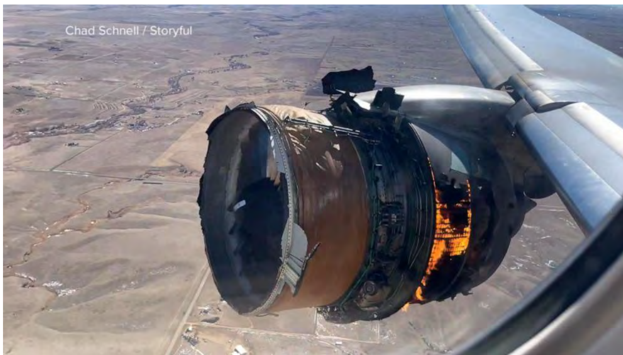
Fig. 208 Turboreactor avion Boeing 777 de la United Airlines care s-a dezintegrat datorită ruperii a două pale din turbină ca urmare a fenomenelor de oboseală termică [video].
