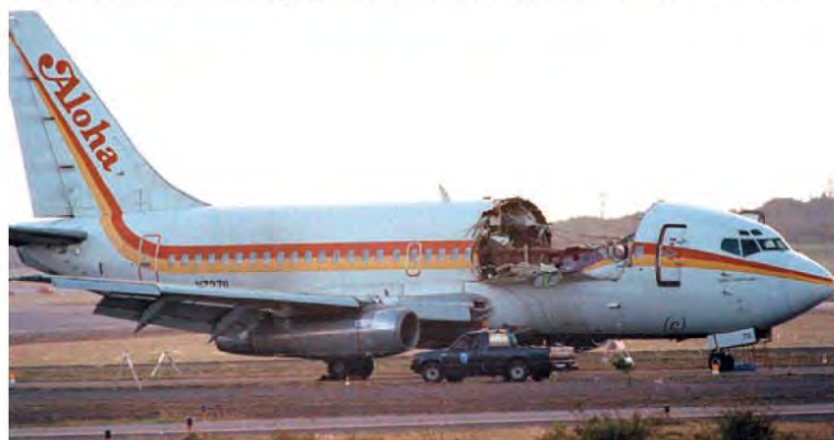
Fig. 149 Avarii la fuselajul unui avion Boeing de linie datorită fenomenelor de oboseală mecanică și coroziune [8].
