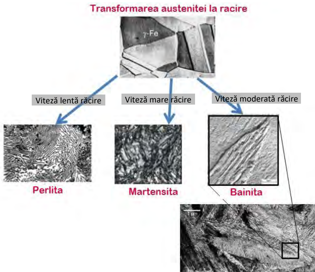
Fig.189 Transformarea austenitei la răcire pentru un oțel eutectoid. Viteze de răcire și microstructuri.
