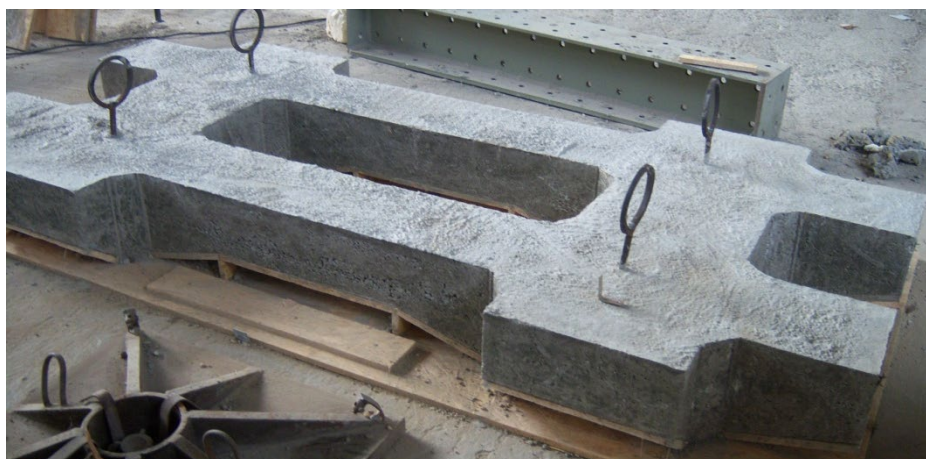
Figura 5.6 Traversa după decofrare laterală
