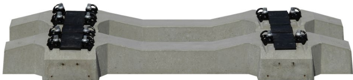
Figura 5.2 Reprezentare 3D a traversei cadru în Solid Works
