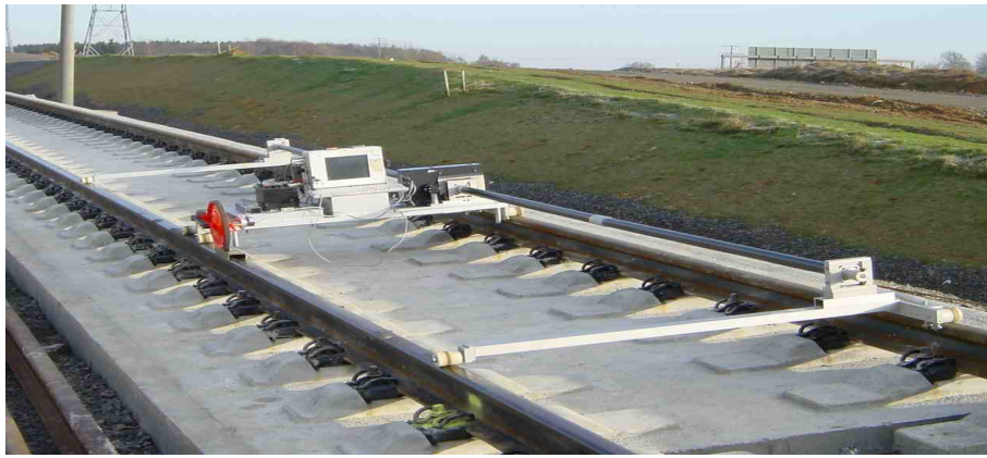
Figura 2.18 Suprastructură Rheda Japonia, măsurători ale ecartamentului [16]
