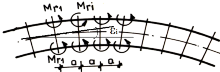
Figura 4.56 Momentul rezistent în prinderi [24]
