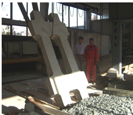
Figura 5.8 Așezarea traversei cadru pe patul de piatră spartă
