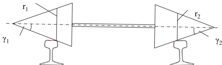
Figura 3.2 Conicitatea bandajului roții [23]
