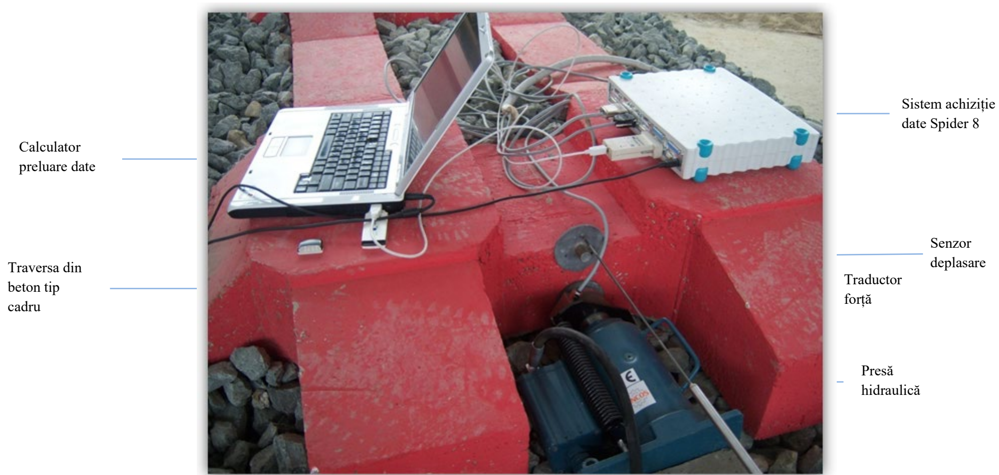
Figura 5.12 Elementele necesare testării: presa și senzorii
